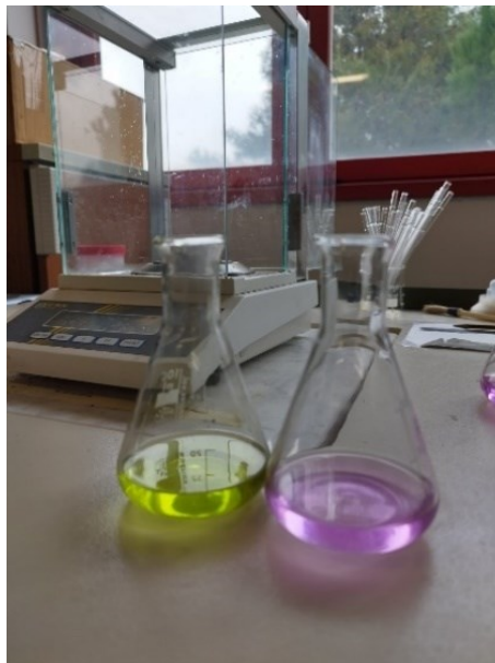
Figura 12. Soluzione di KOH e diethyl etere prima e dopo l'aggiunta di olio
