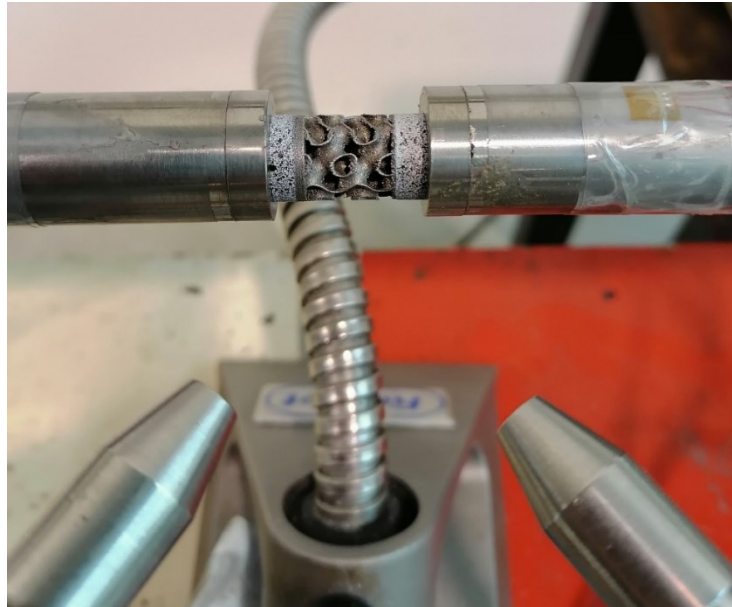
Figura 35 Set-Up del provino non filettato sulla barra
