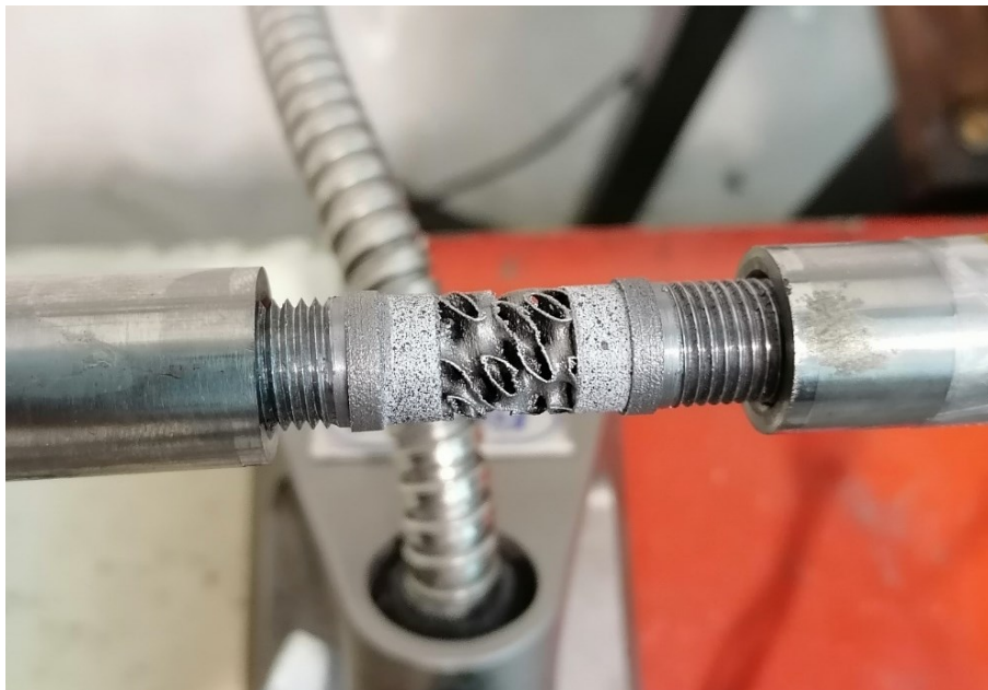
Figura 42 Set-Up del provino avvitato (parzialmente) ad entrambe le barre
