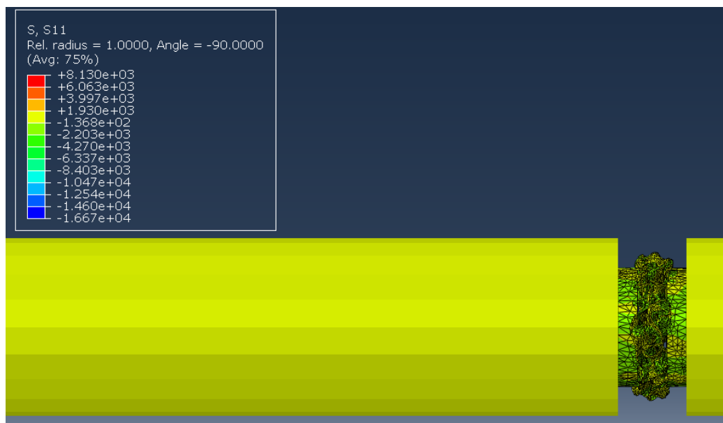
Figura 54 Step400 della simulazione: l'onda ha deformato completamente il provino Gy
