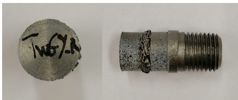
Figura 32 Provino compresso staticamente (Test TwGy_free)
