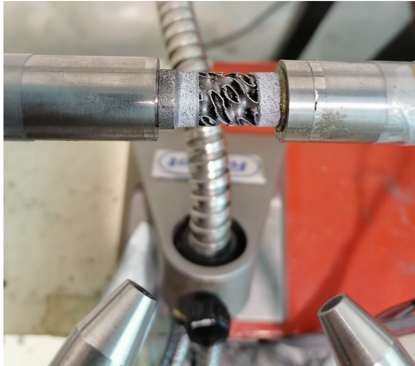
Figura 39 Set-Up del provino avvitato ad un estremo della barra
