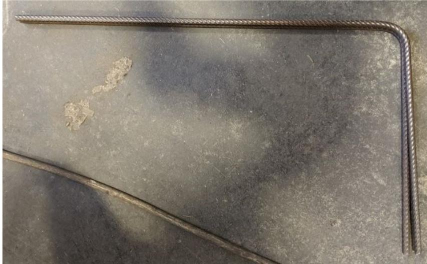
Figura 8.13: Staffe realizzate con due diversi settaggi del mandrino
