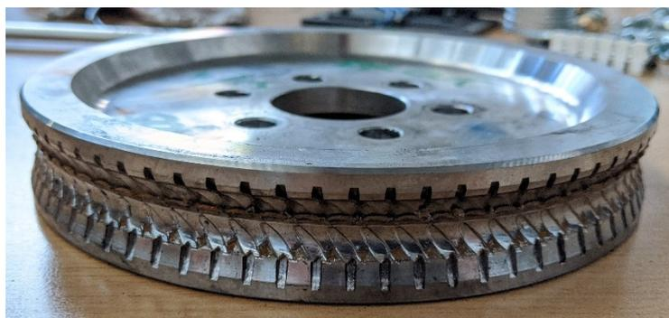
Figura 11.2: Ruota inferiore di traino usurata
