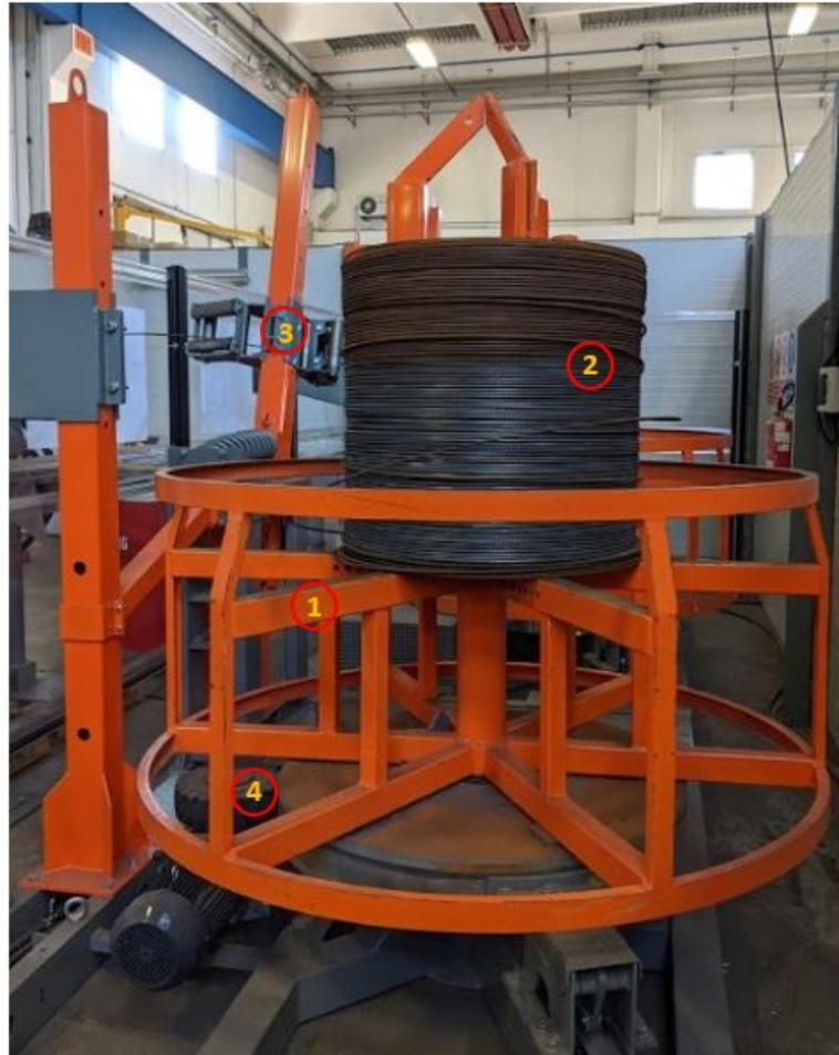
Figura 7.1: Sistema di stoccaggio (aspo) con la bobina di ferro
