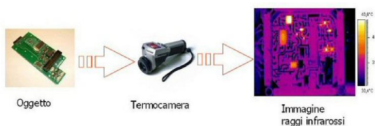
Figura 4.9: Processo termografico tramite termocamera
