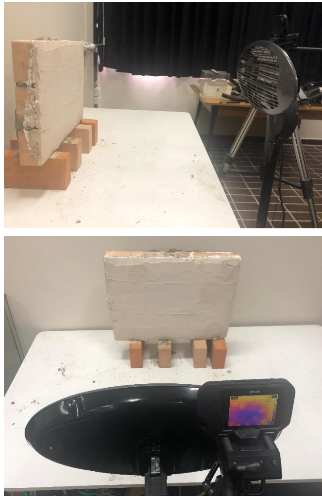
Figura 5.15: Set-up per le acquisizioni dei termogrammi
