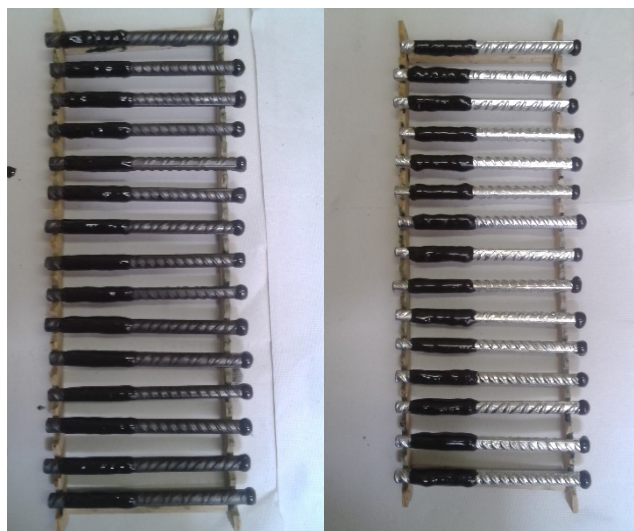
Figura 96 Barre di armatura resinate
