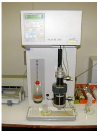
Figura 71 Porosimetro a mercurio
