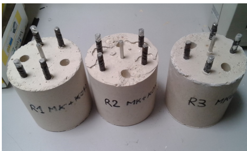
Figura 94 Provini di malta geopolimerica a base di metacaolino scasserati
