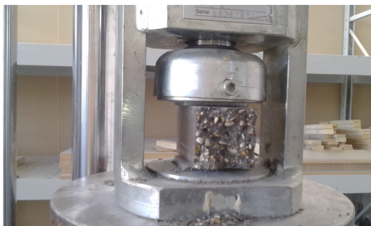
Figura 38 Campione sottoposto a rottura per compressione
