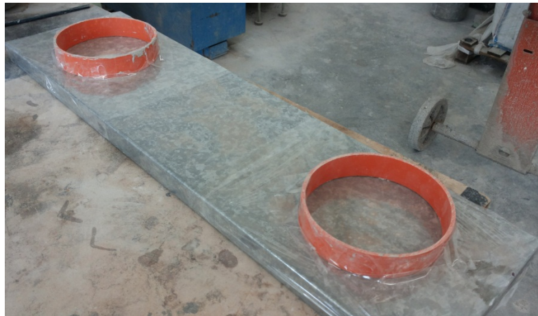
Figura 21 Anelli di formatura in PVC su supporto in alluminio
