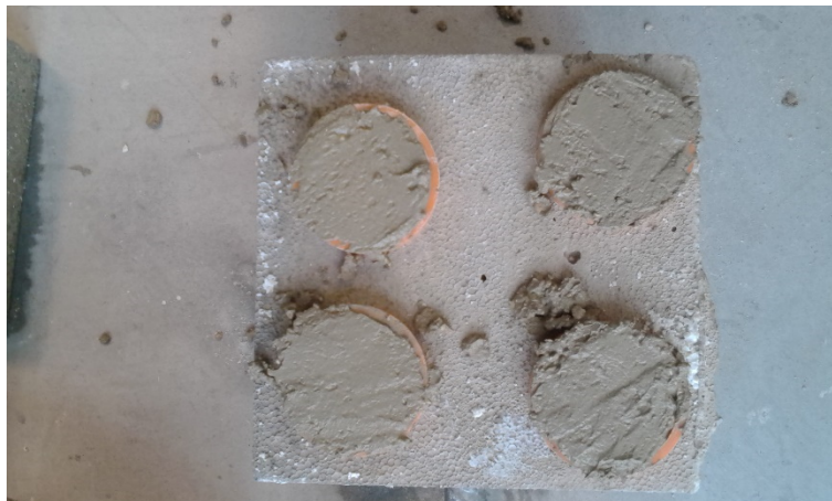
Figura 20 Blocchi in calcestruzzo in cui sono stati gettati i campioni per le prove di aderenza
