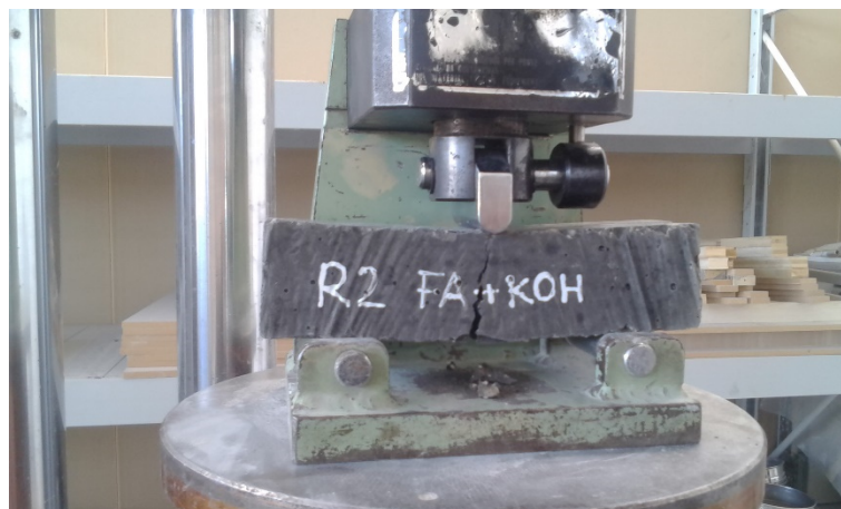
Figura 33 Provino sottoposto a rottura per flessione
