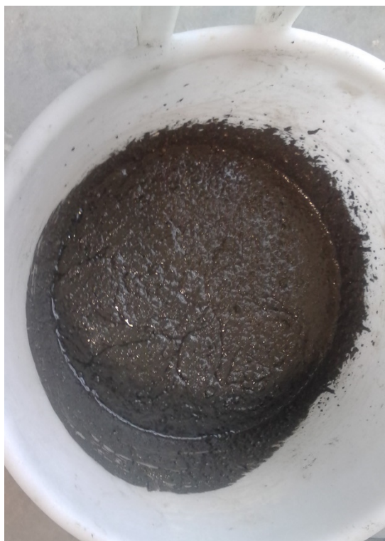
Figura 18 Impasto geopolimerico a base di cenere volante ottenuto dopo la miscelazione con un trapano
