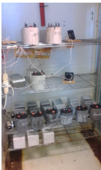
Figura 100 Vista dell'interno della camera di carbonatazione accelerata
