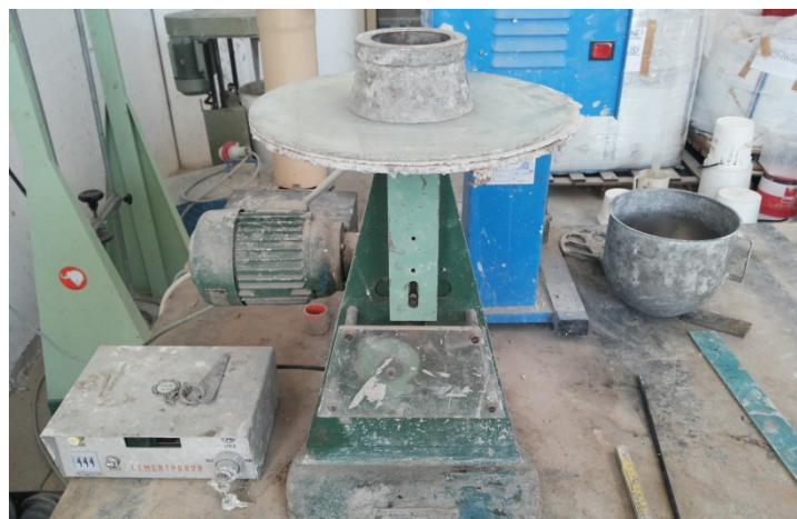
Figura 24 Tavola a scosse per slump test con forma metallica troncoconica
