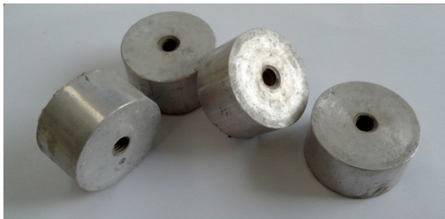
Figura 52 Piastre in alluminio utilizzate nella prova di aderenza
