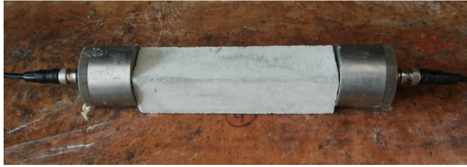
Figura 44 Provino sottoposto a rilevazione ultrasonica con l'ausilio di trasduttori
