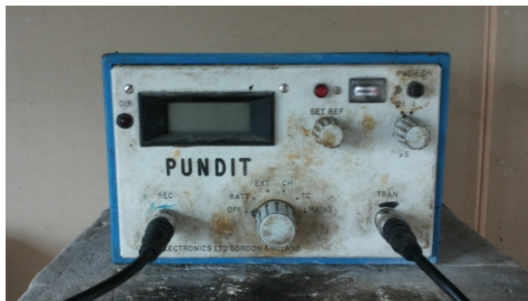
Figura 43 Dispositivo di rilevazione della velocità degli impulsi ultrasonici
