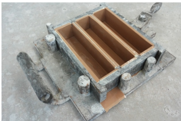
Figura 17 Cassero di formatura 40x40x160 mm a incastro rivestito con nastro adesivo
