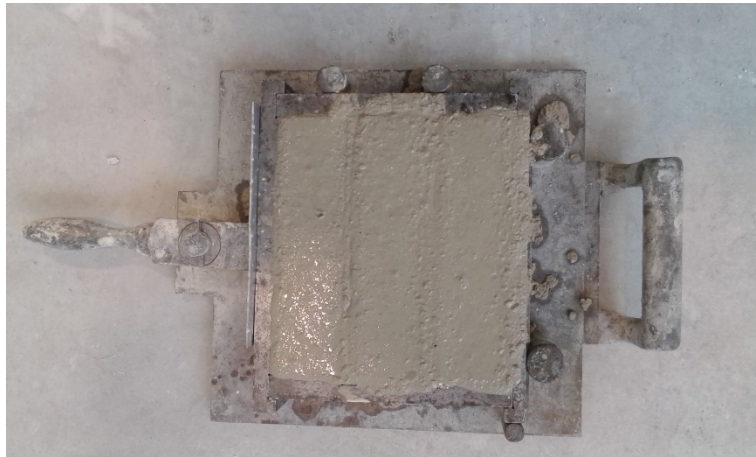
Figura 19 Malta in cemento nel cassero di formatura
