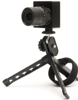
Figura 1: Camera DVS. Immagine tratta da [1]
