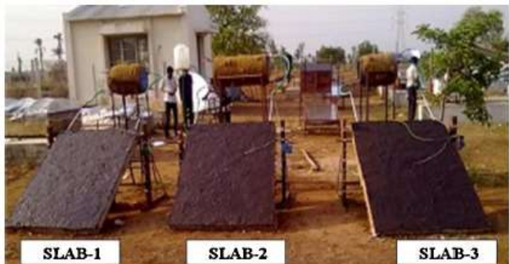
Figura 17 Collettori solari in calcestruzzo: Slab1 materiale conduttivo e tubi in alluminio, Slab2 materiale conduttivo e tubi in PVC e Slab3 materiale non conduttivo e tubi in PVC [24]
