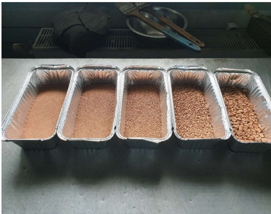
Figura 48 Classi granulometriche ottenute. Da destra verso sinistra 4-8 mm, 2-4 mm, 1-2 mm, 0.5-1 mm e 0-0.5 mm.
