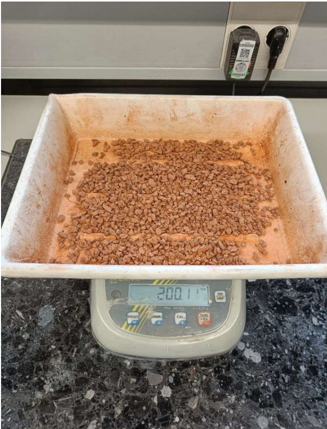
Figura 53_ Pesatura iniziale della massa del campione
