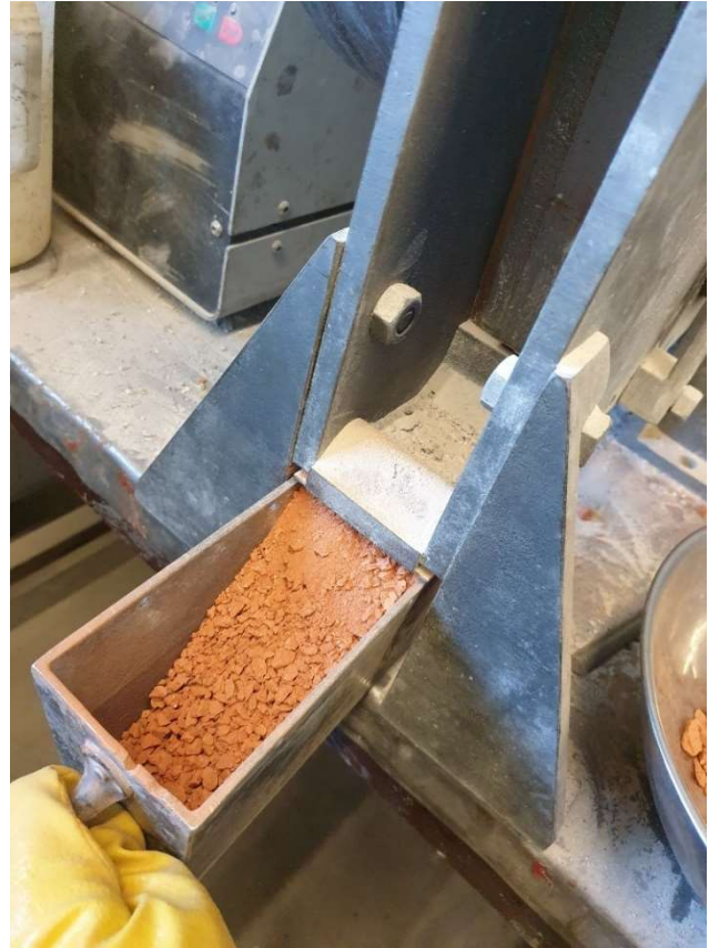
Figura 47 Materiale risultante dalla macinazione del blocco Poroton
