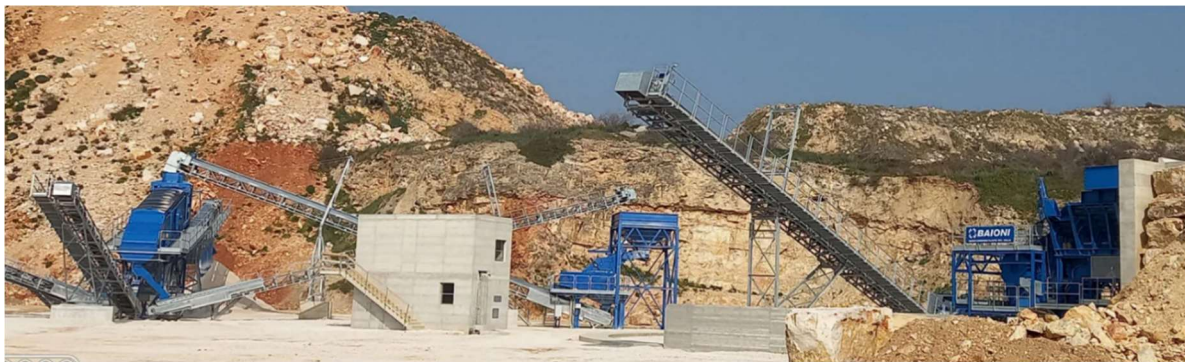
Figura 33 _Esempio di impianto di frantumazione [57]
