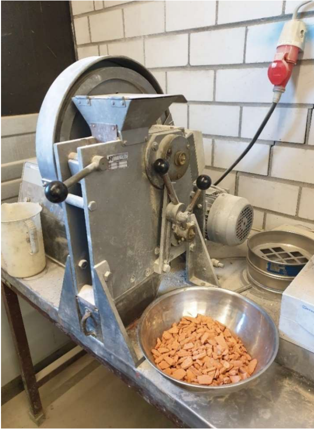
Figura 46 Frantoio a mascelle utilizzato per la formazione dell'aggregato
