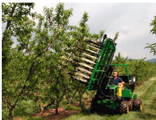
Figura 20: diradamento effettuato tramite scuotitore su alberi allevati con forma a V
