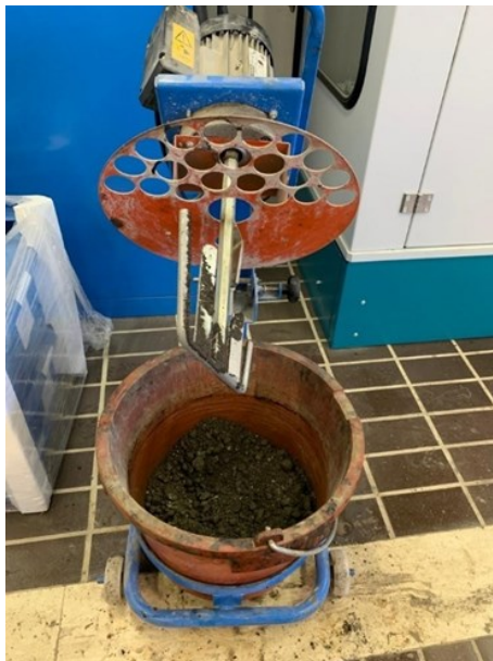
Figura 17- impasto terminato e pronto alla compattazione
