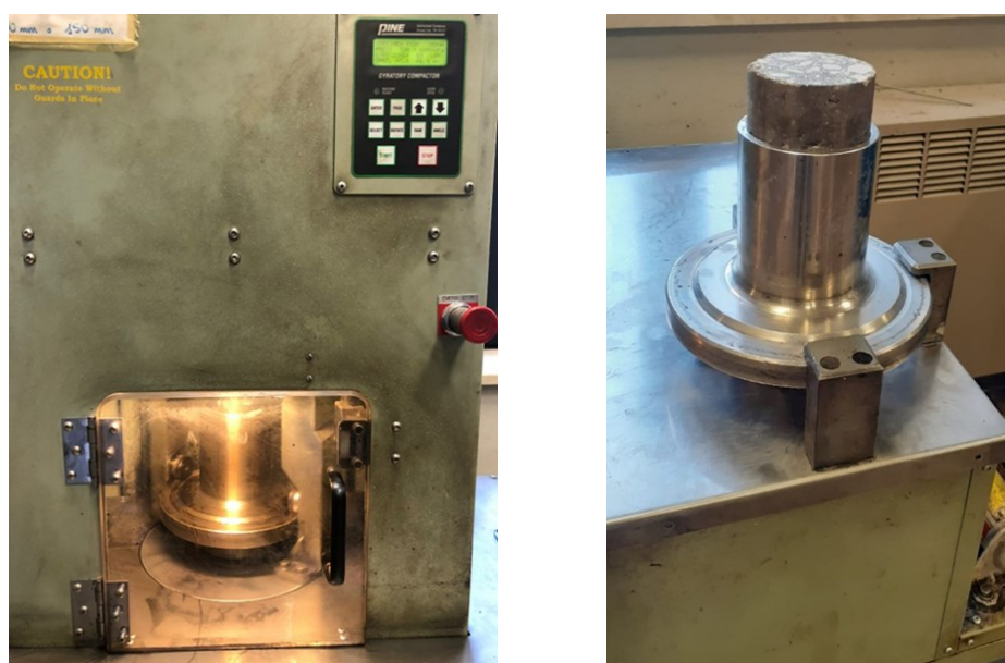
Figure 19/20- compattazione in opera / estrazione del provino mediante pressa idraulica
