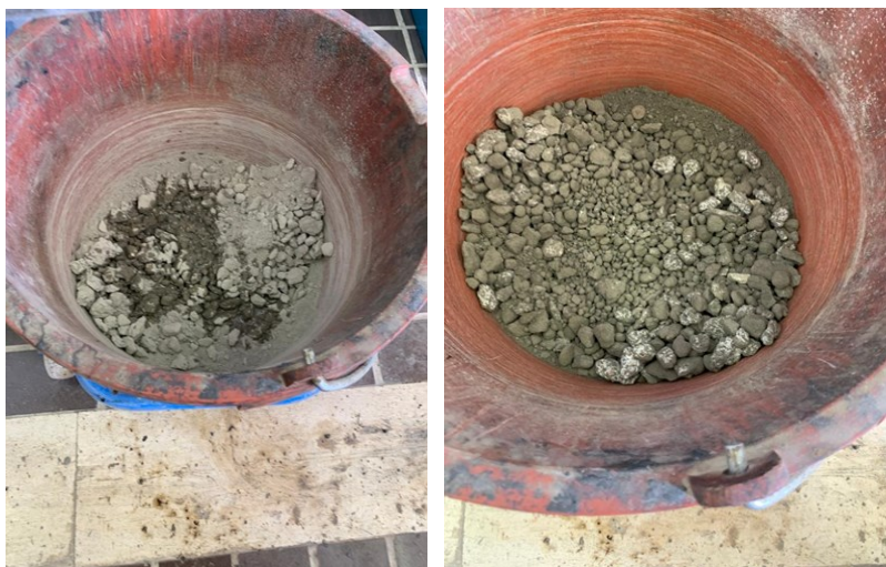
Figure 13/14- aggiunta di acqua all'impasto / impasto miscelato con acqua
