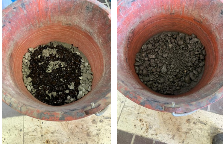
Figure 15/16- aggiunta di emulsione all'impasto / impasto miscelato con emulsione
