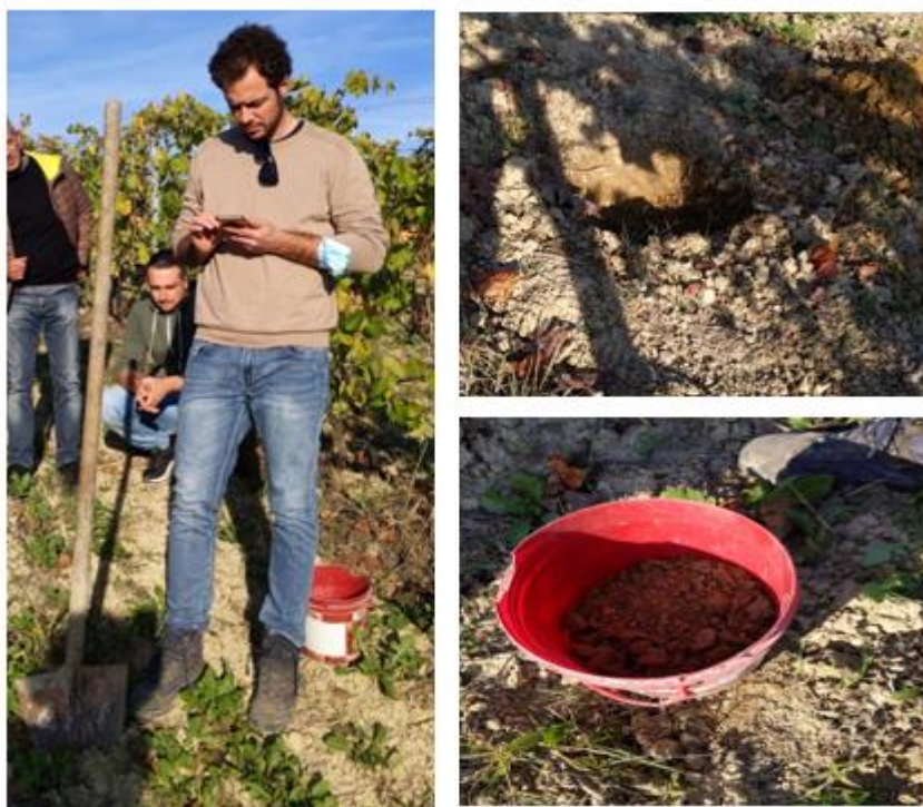
Figura 12: passaggi del campionamento del terreno
