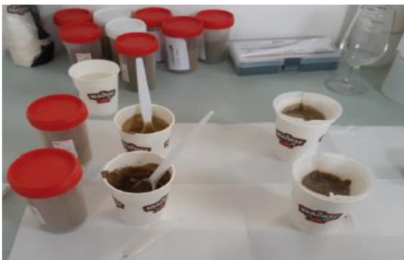
Figura 14: campioni di terreno messi a contatto con la soluzione reagente
