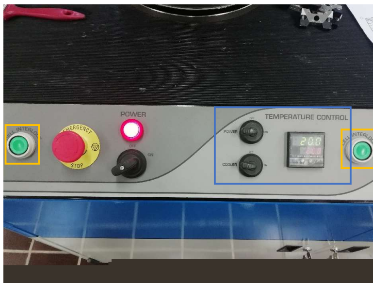
Figura 42- Pulsanti per abbassare la campana in giallo e temperature control blu
