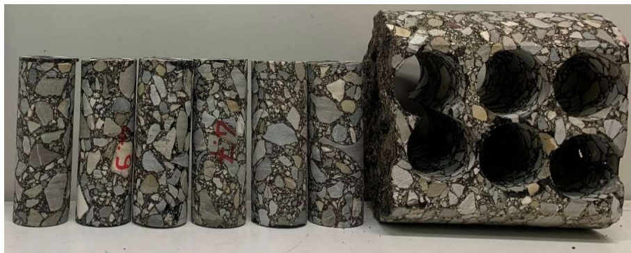
Figura 13- Provini ottenuti da carote prelevate in sito: (a) strato di binder e (b) strato di base.
