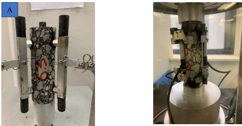
Figura 25 – a: Macchina per il montaggio riscontri con base da 38mm, b: setup di prova
