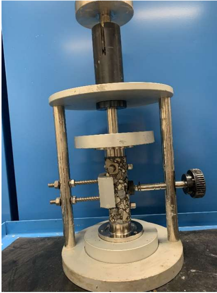
Figura 37 - Attrezzatura per incollaggio delle teste di carico
