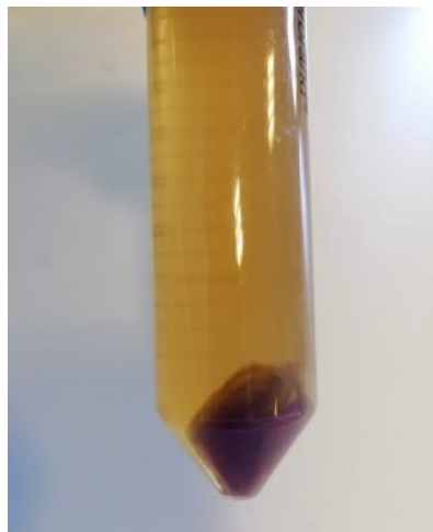
Figura 3: Risultato dopo la centrifugazione degli estratti acquosi di O. tauricum . In giallo, l'estratto acquoso grezzo (il surnatante). In viola, il residuo solido dei fiori (precipitato).
