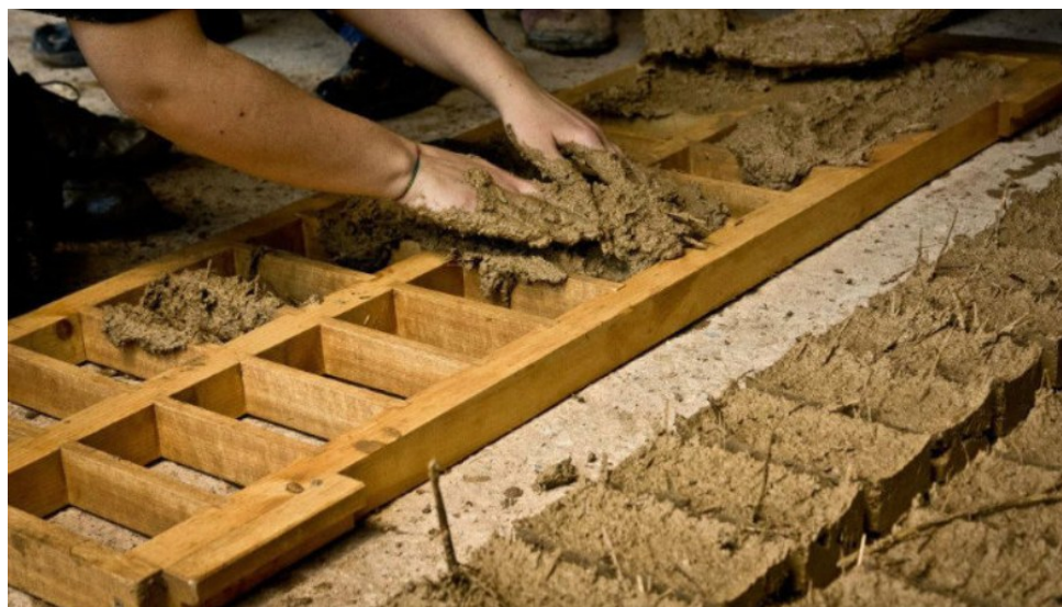
Figura 2-3: Preparazione manuale di mattoni in adobe. (Cosentino, et al., 2019)
