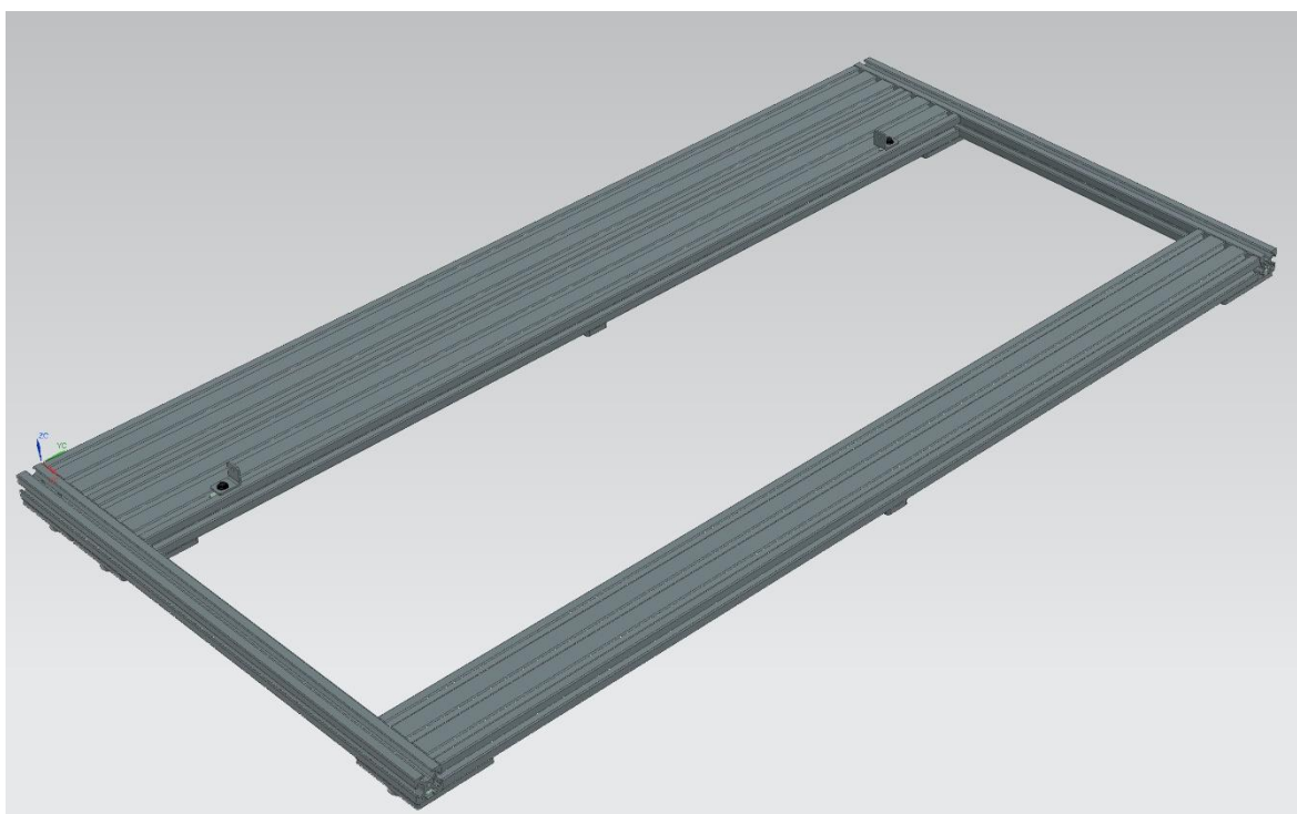
Figura 3.1 Rappresentazione, in vista isometrica, del modello CAD del sottoassieme Base di supporto
