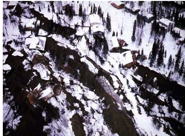
Figura 12: Vista aerea del quartiere di Turnagain Heights, la frana causata dalla liquefazione lo ha completamente distrutto, a seguito del terremoto dell'Alaska del 1964 (immagine presa da www.wikiwand.com )
