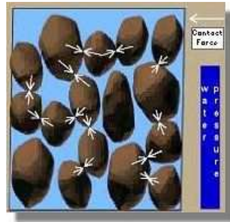
Figura 2: contatti tra particelle solide in condizioni di liquefazione (immagine presa da Università di Washington, Dipartimento di Ingegneria Civile)
