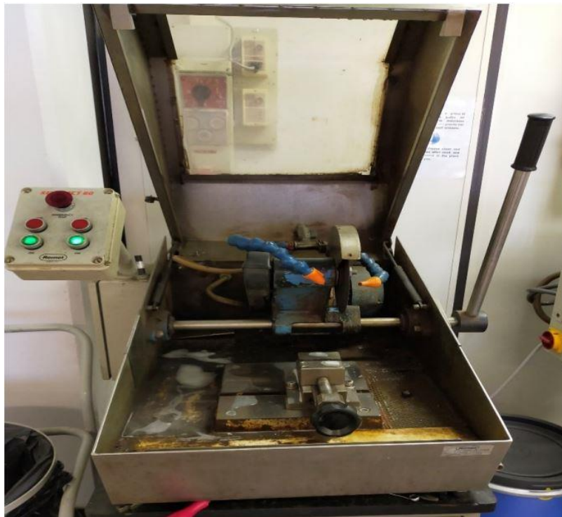
Figura 16 Troncatrice utilizzata per il taglio del campione.
