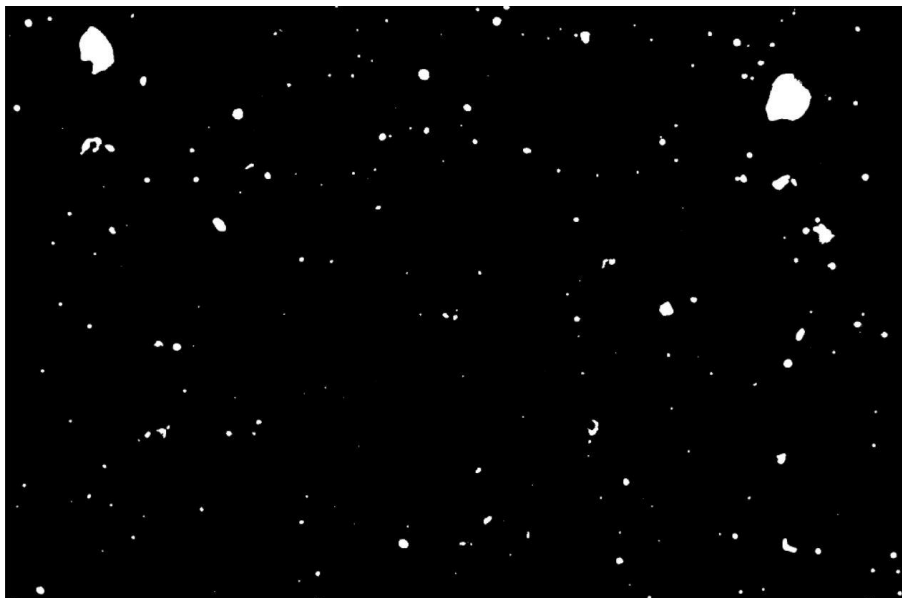
Figura 36.b Vuoti messi in risalto a seguito del comando “Make Binary”.
