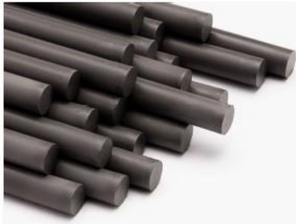
Figura 14 Bacchetta di polvere metallica con legante polimerico e cera [9].
