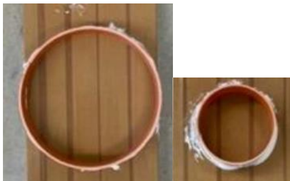
Figura 16 Casseri per prove di permeabilità al vapore e di MBV (da sinistra a destra)
