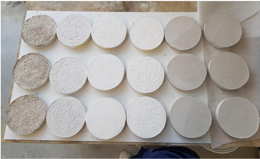
Figura 27 Provini cilindrici per la prova di permeabilità al valor d'acqua
