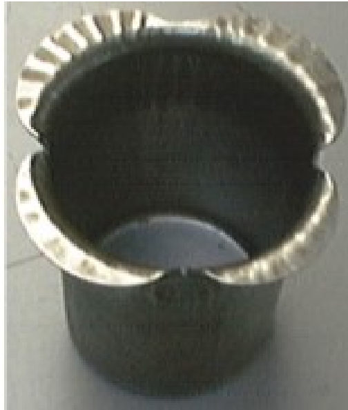
Figura 2.11 – Difetto di formazione delle orecchie su un pezzo meccanico
