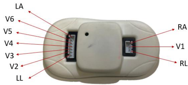
Figura 19 WECG pin e derivazioni
