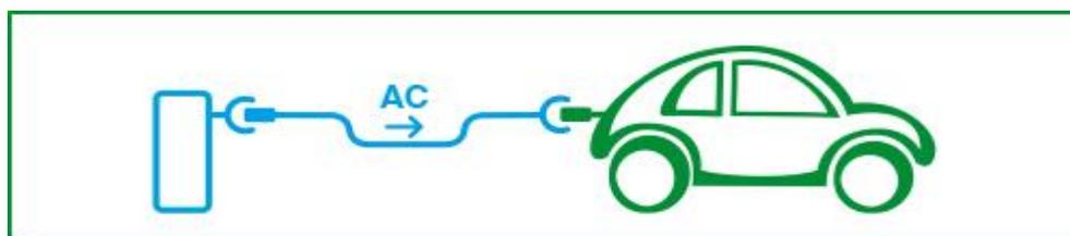
Figura 23: esempio di impostazione per una ricarica Modo 1. [Fonte: E-Station]
