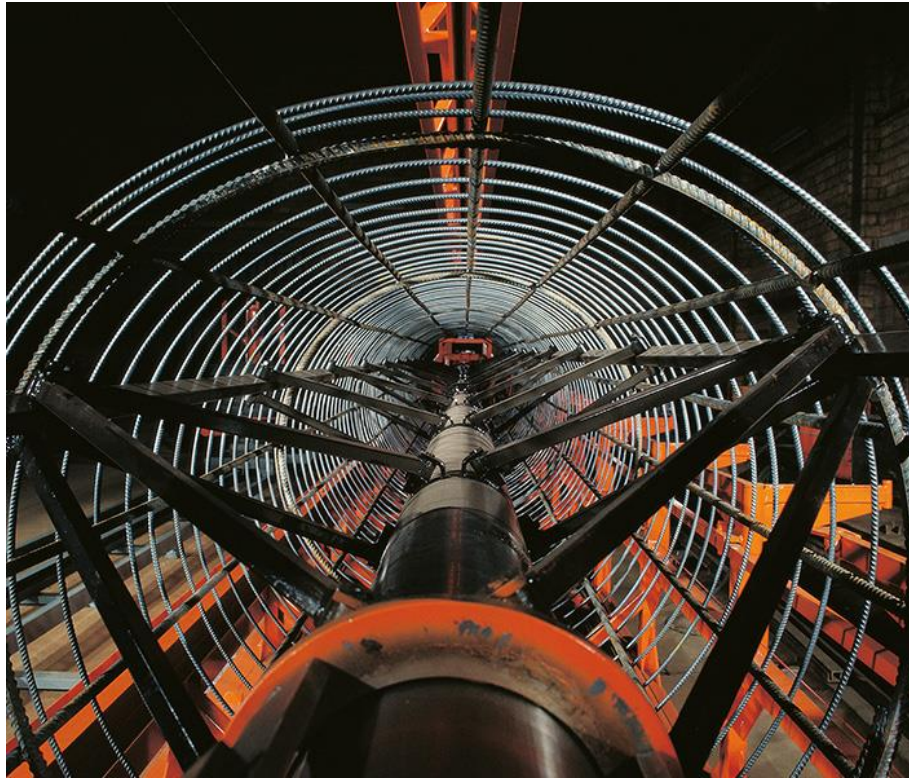
Figura n. 8: ROLL macchina per la produzione di gabbie cilindriche.
