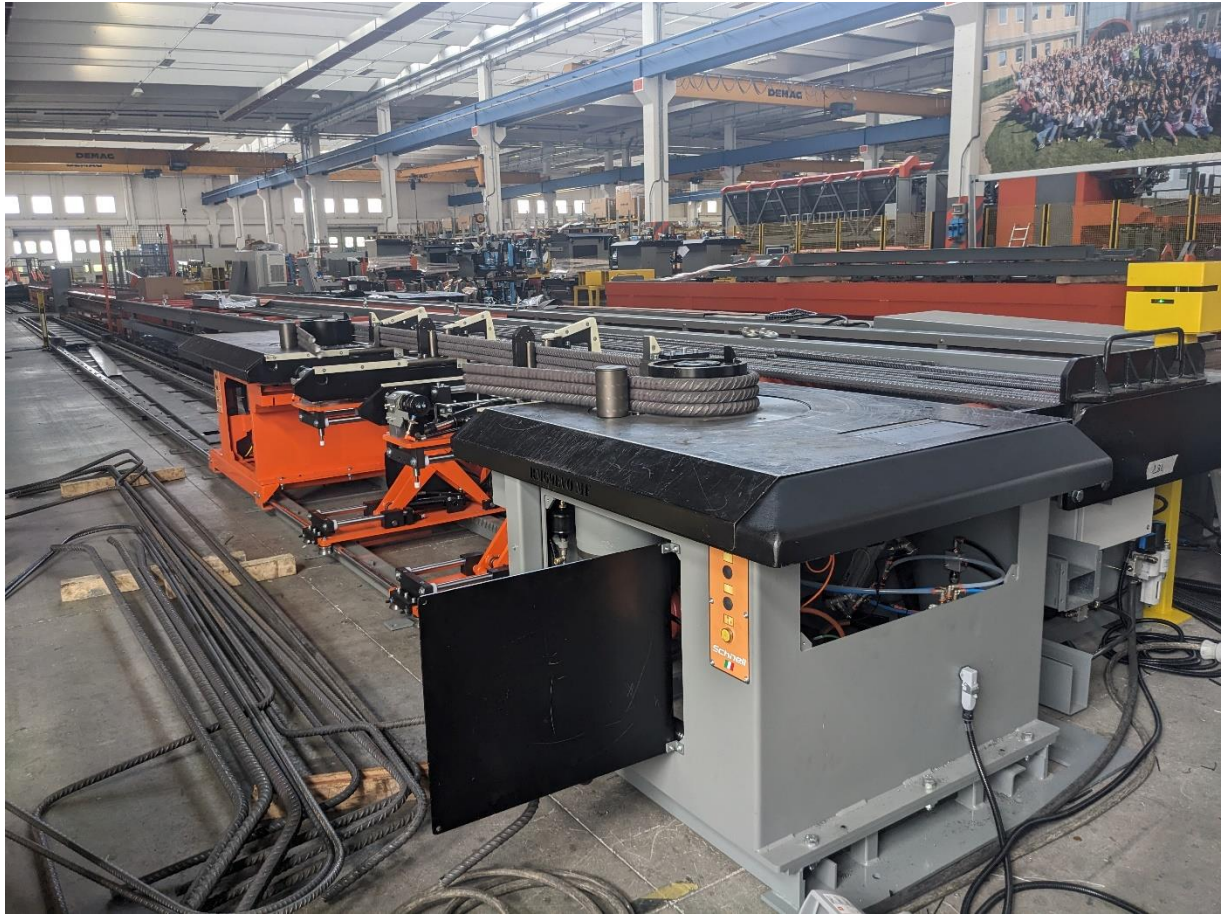
Figura n. 22: ROBOMASTER 60 EVO V1 cULus in fase di sagomatura di un tondino
