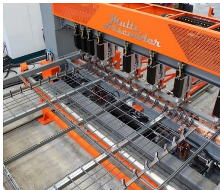
Figura n. 10: Multi Assembler per la produzione di reti piane o tridimensionali o per pre-assemblare parti di grandi gabbie
