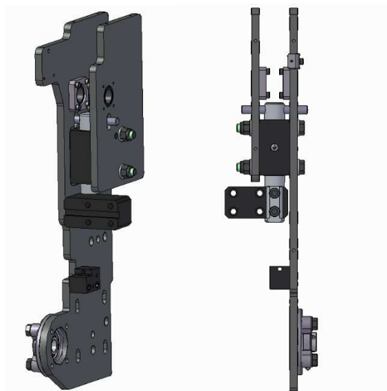
Figura 24 Vista isometrica e frontale dell'insieme di supporto del piastrone
