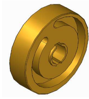
Figura 25 Camma con scavo elicoidale
