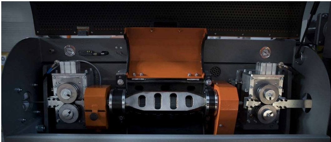
Figura 5 Rotore e traino della raddrizzatrice R8
