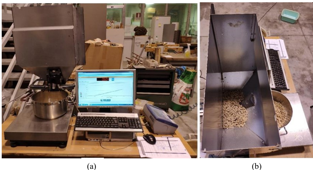
Figura 9: (a) Strumentazione test di portata; (b) Dettaglio serbatoio stufa
