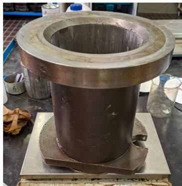
*Figura 11- Fustella con diametro da 150mm*
