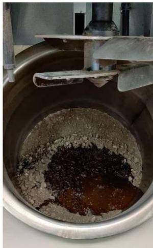
*Figura 9 – Emulsione bituminosa nel miscelatore*
