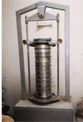
Figura 5 Pila di setacci posizionata nel vibro-vaglio
