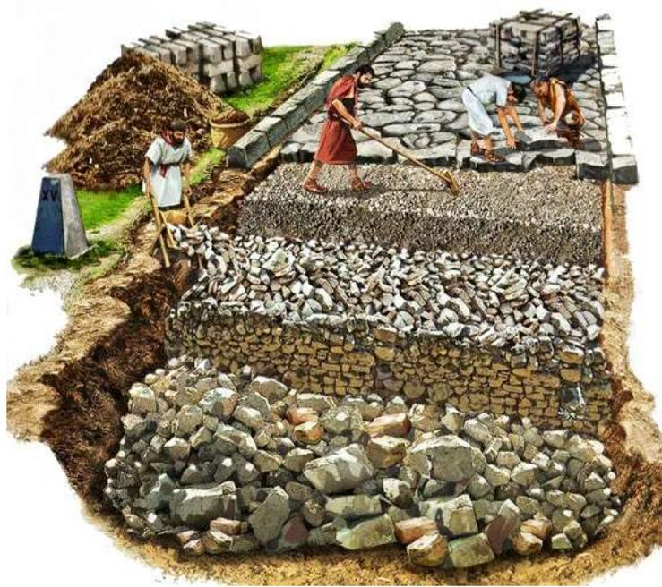
Figura 1 - Configurazione tipica di una strada romana
