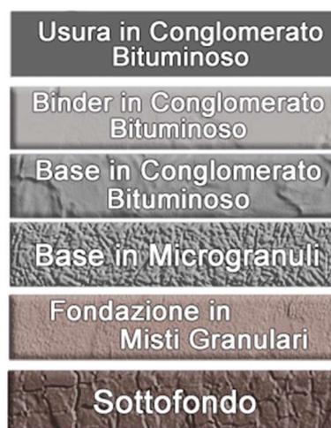
Figura 2 - Stratigrafia di un pacchetto strutturale di una pavimentazione stradale semirigida
