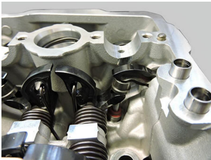
Figura 1.3 - Testata motore con distribuzione desmodromica [4]
