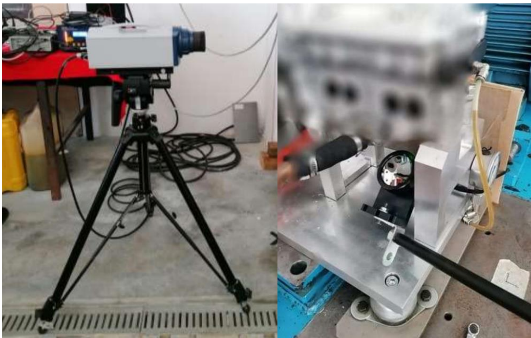
Figura 1.17 - Posizione del vibrometro e dello specchio nella scena di misura [2]
