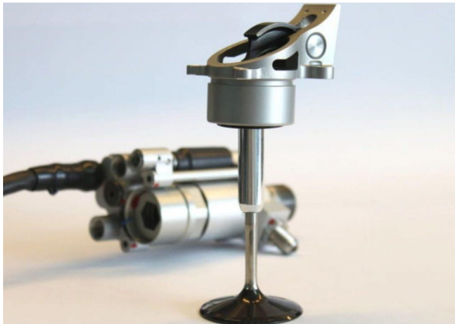
Figura 1.2 - Sistema di richiamo valvola pneumatico
