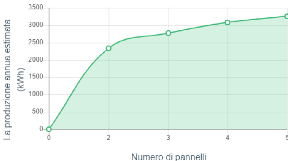
Grafico 14 Stima della produzione annua di energia termica con due pannelli solari (Daikin, s.d.)
