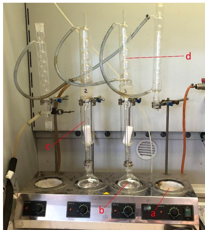
Figura 18 - Estrattore Soxhlet (c); mantello riscaldante (a); pallone (b); condensatore a bolle (d)
