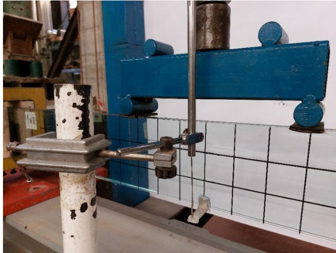
Figura 19 – Trasduttore di spostamento incollato alla staffa, a sua volta incollata alla trave
