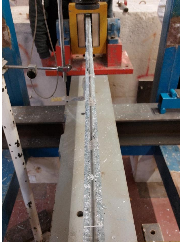
Figura 90 - Modalità di rottura PROVINO RL3
