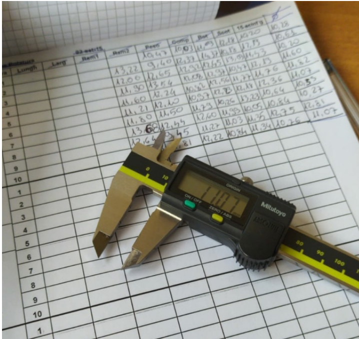
Figura 3-8: Calibro digitale utilizzato per misurare il diametro e scheda usata per la registrazione dei dati.
