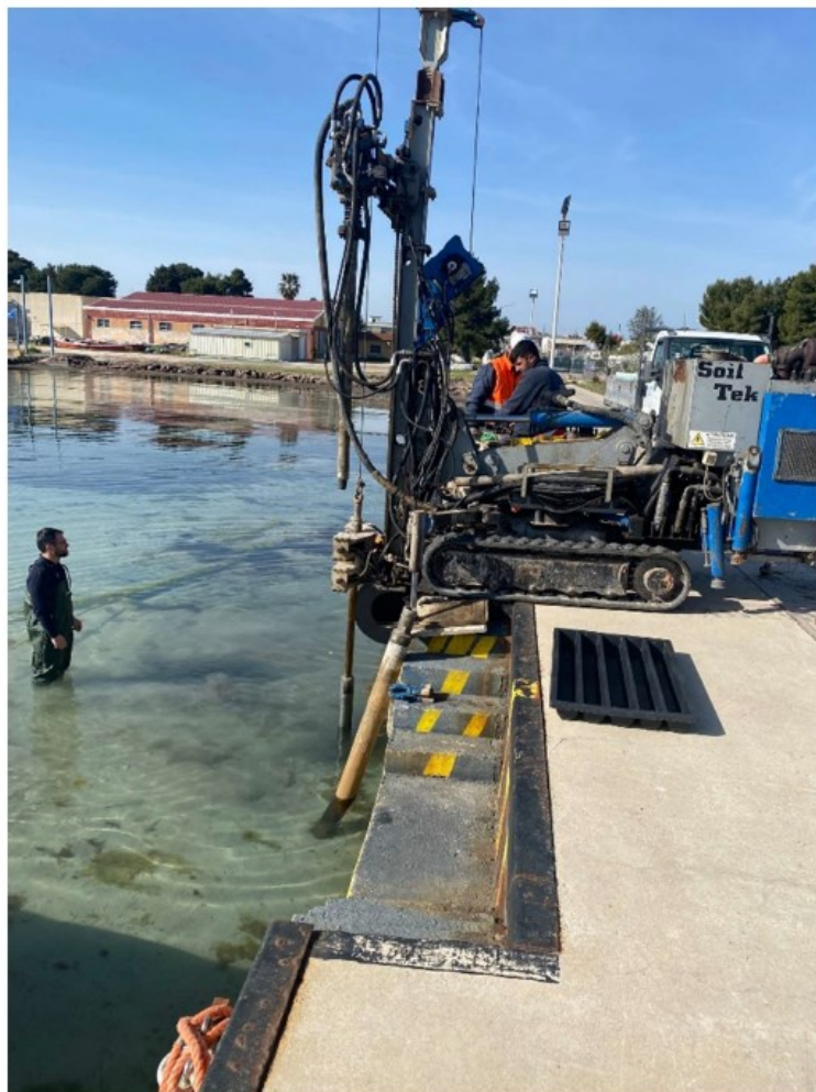
Fig. 2.9 – Carotiere posto in corrispondenza di un punto di campionamento alla testata del molo.
