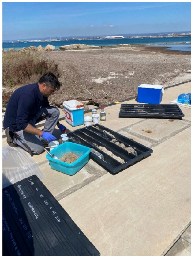
Fig. 3.1 – Chimico che prepara le aliquote prelevate dalle carote riposte nelle cassette catalogatrici, da sottoporre ad analisi.
