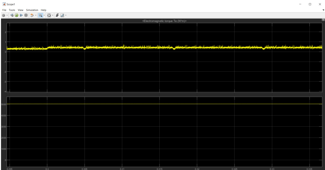
Figura 36: La coppia elettromagnetica sviluppata al rotore sopra riportata incrementa da 0.3 Nm a 0.42 Nm nell'istante in cui si verifica la coppia d'attrito. Come si vede nell'immagine, la coppia complessiva subisce periodicamente dei cali rapidi di breve durata, corrispondenti alla rottura del cuscinetto.
