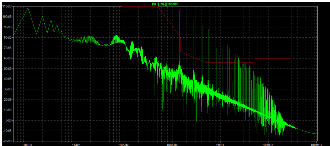
Figura 3.3.: Simulazione LT-SPICE: modo comune con maschera limiti CISPR
