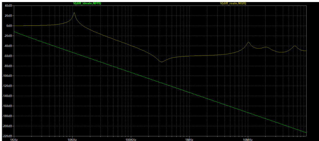
Figura 5.4.: Comportamento in frequenza del filtro in modo differenziale
