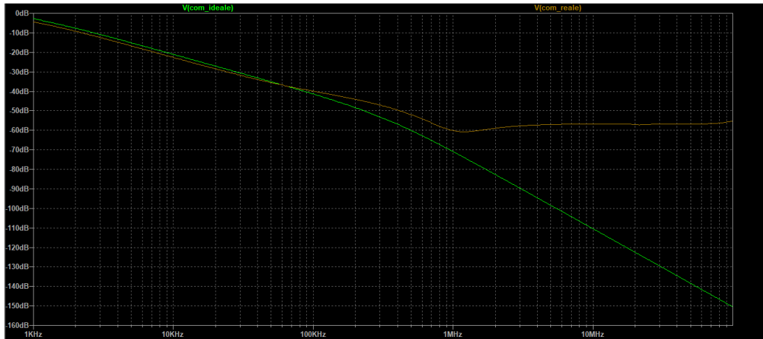
Figura 5.3.: Comportamento in frequenza del filtro in modo comune
