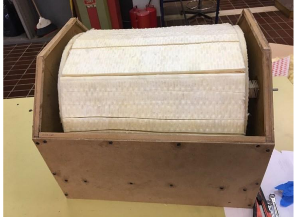
Fig. 27 - Riempimento fessure con materiale isolante
