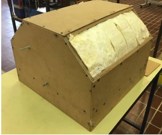
Fig. 27 - Riempimento fessure con materiale isolante
