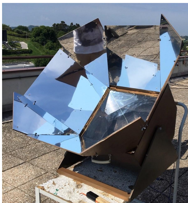
Fig. 32 - Forno solare ultimato (Principali modifiche)
