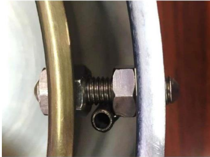
Fig. 47 - Sistema di fissaggio delle pentole con tubicino in acciaio INOX per il passaggio delle termocoppie.
