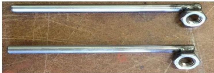
Fig. 48 - Tubicini in acciaio INOX saldati ai bulloni
