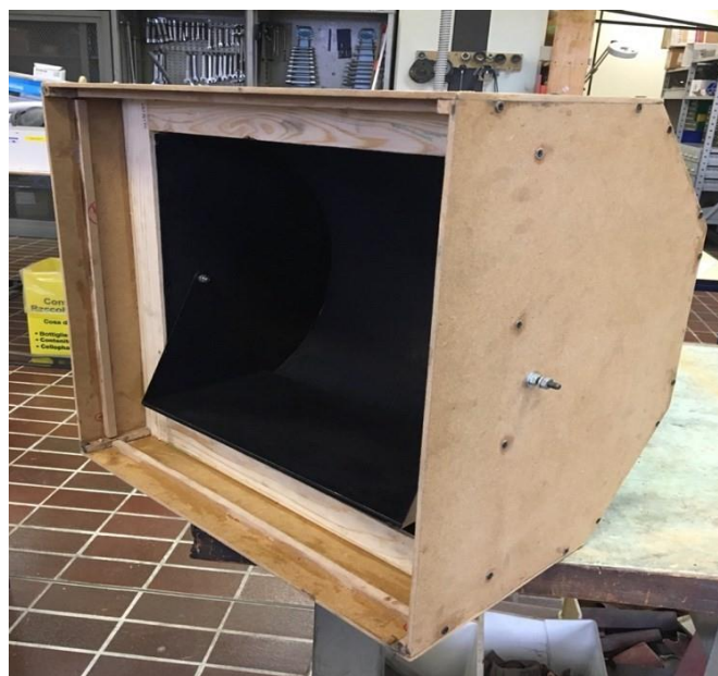
Fig. 25 - Inserimento camera di cottura nell'involucro esterno
