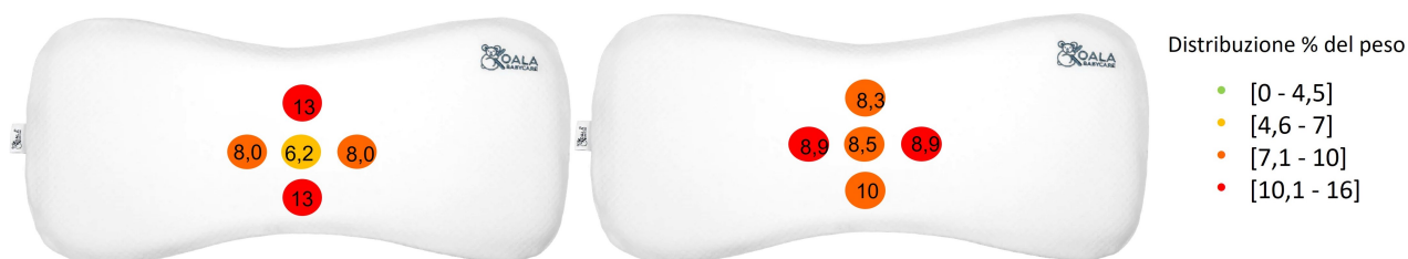
Figura 4.3: Confronto sul cuscino Perfect Head Maxi (a sinistra 390 grammi, a destra 1100 grammi) in termini di distribuzione percentuale del peso
