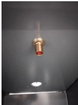
Raccordo in ottone del sistema di pulitura dei trucoli e foro per il passaggio del visualizzatore d'angolo
