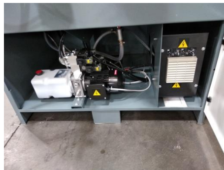
Variatore montato nell'apposito vano
