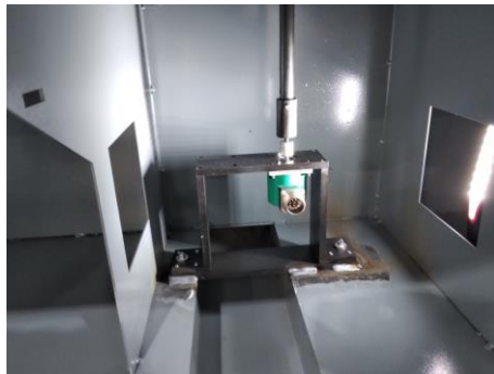
Encoder collegato al perno e fissato al basamento
