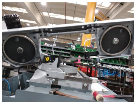
Archetto con nastro e pulegge montati
