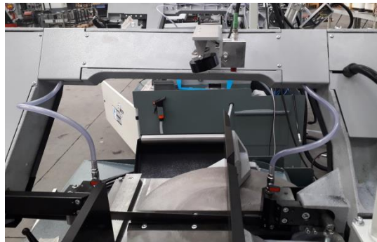
Blocco laser-lampada montato sull'archetto
