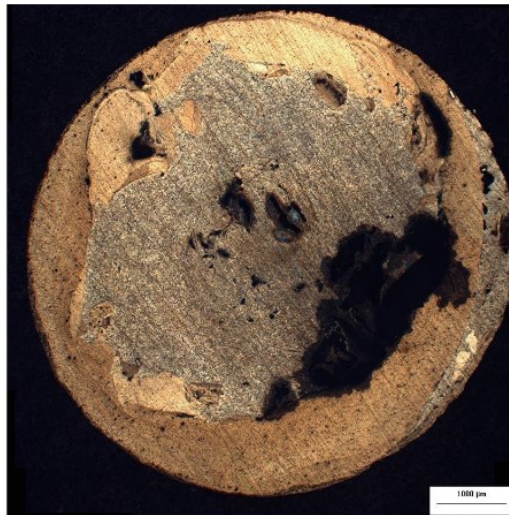
Figura 5.13 - Panoramica attacco chimico sezione del campione "1"
