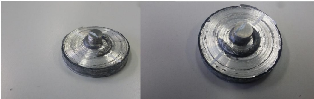
Figura 5.15 - Campione "2" in fase di preparazione dopo aver subito il primo taglio
