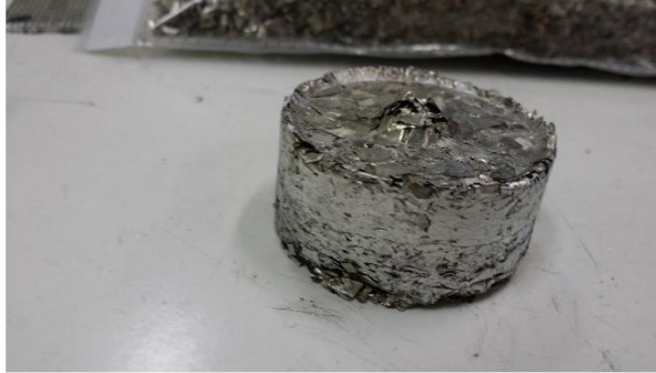
Figura 5.26 - Provino compattato a 200 kN
