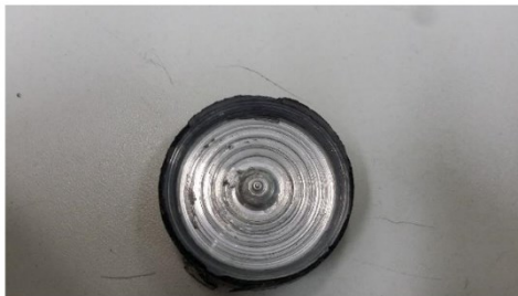
Figura 5.31 - Pasticca consumata dopo la prova
