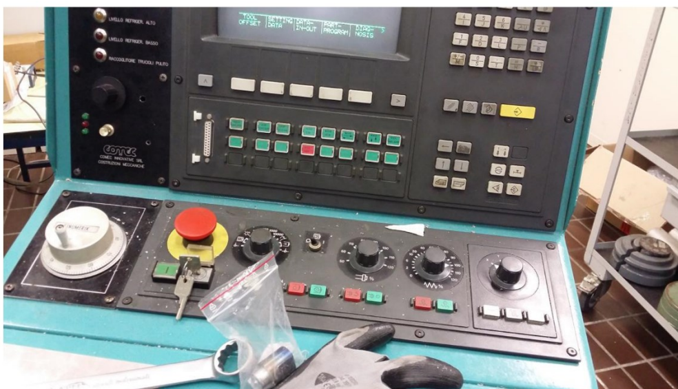
Figura 4.9 - Computer di controllo della macchina CNC, modulo digitale e controllo online
