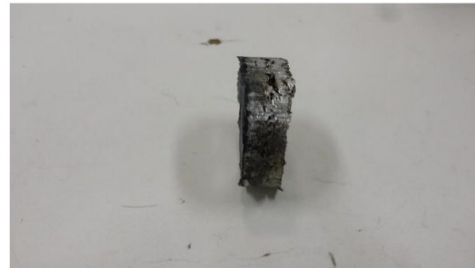
Figura 5.31 - Pasticca consumata dopo la prova
