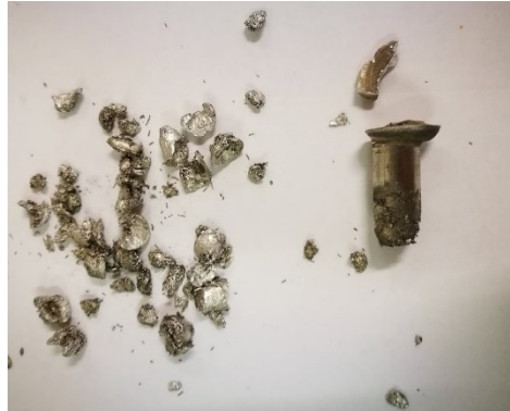
Figura 5.9 - Estruso della lega di magnesio AZ31
