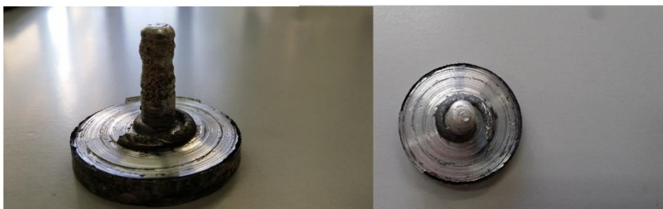
Figura 5.10 - Campione 2, residuo di pasticca della prova 1 bis
