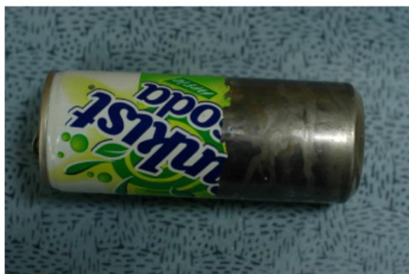
Figura 2.3 - Campione di UBC sottoposto a decoating
