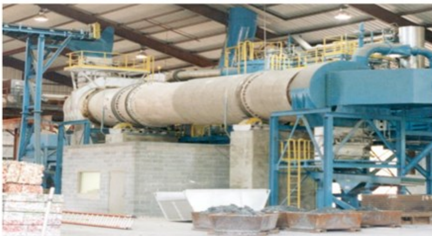
Figura 2.1 - Tamburo rotante di un sistema di decoating, ovvero un forno di pirolizzazione
