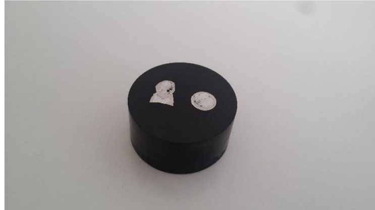
Figura 5.12 - Provino inglobato delle due parti del campione "1"
