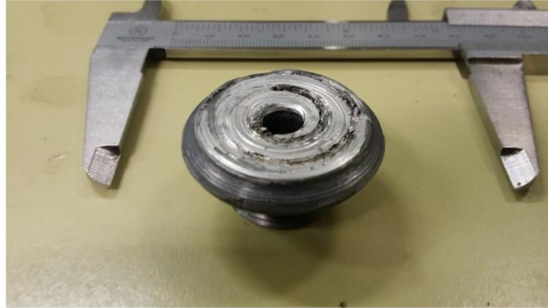
Figura 6.2 - Rottura della testina che risulta completamente distrutta nella parte esterna
