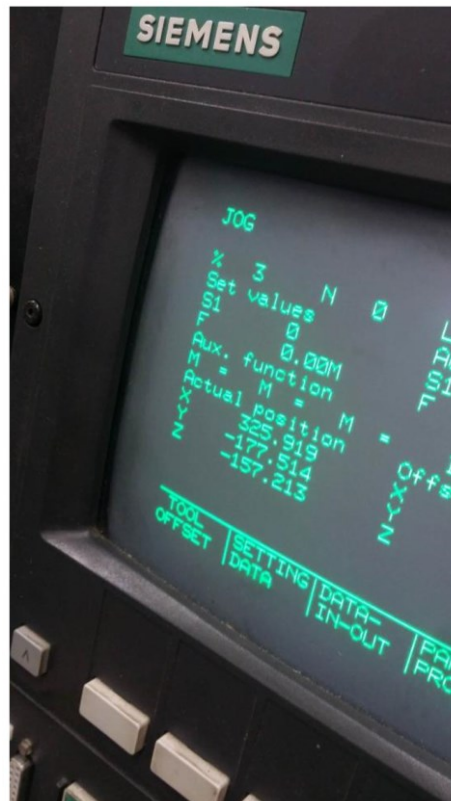
Figura 4.8 - "Actual position" del punzone rispetto allo zero macchina
