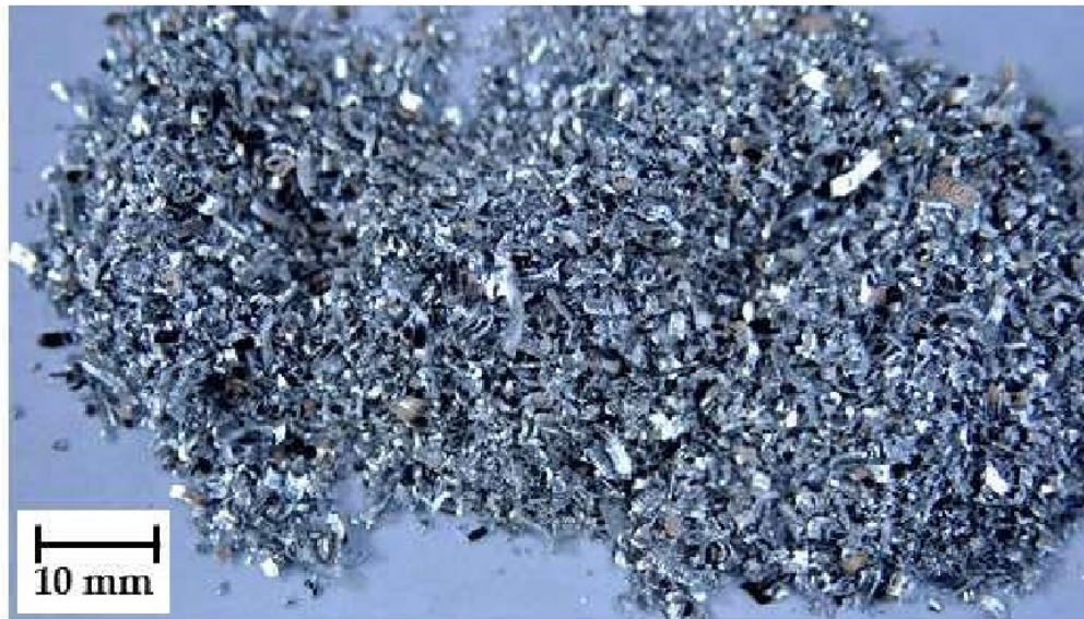
Figura 4.3 - Trucioli di Magnesio
