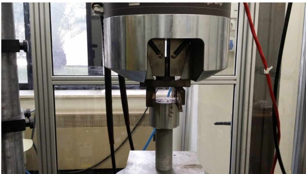
Figura 4.4 - Material Test System con componenti per la precompattazione
