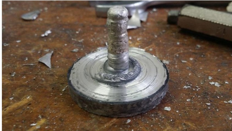
Figure 5.2 - Estruso lega 1000 di Alluminio
