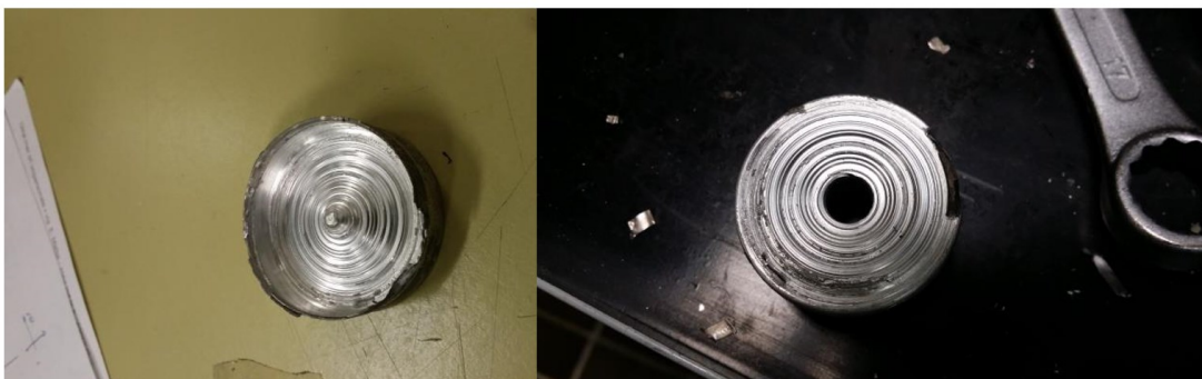
Figura 5.5 - Tentativo di estrusione della lega 5457 della prova 4
