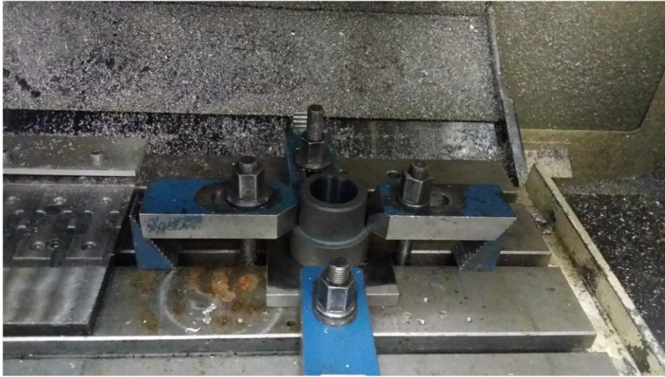
Figura 4.6 - Bloccaggio dei componenti sulla macchina CNC
