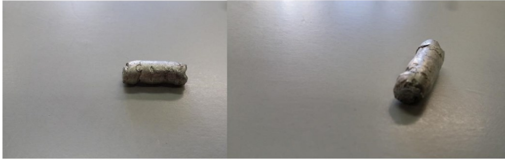
Figura 5.11 - Campione 1, estruso della lega 1000 entrato nel canale della filiera
