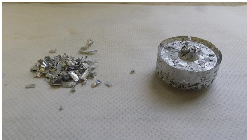
Figura 4.2- Trucioli di Alluminio "liberi" e trucioli compattati
