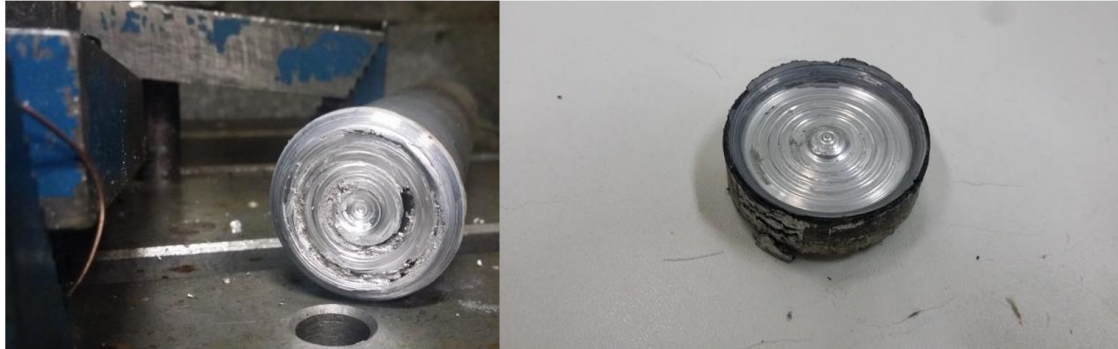
Figura 5.6 - Riempimento canali e consumo della pasticca
