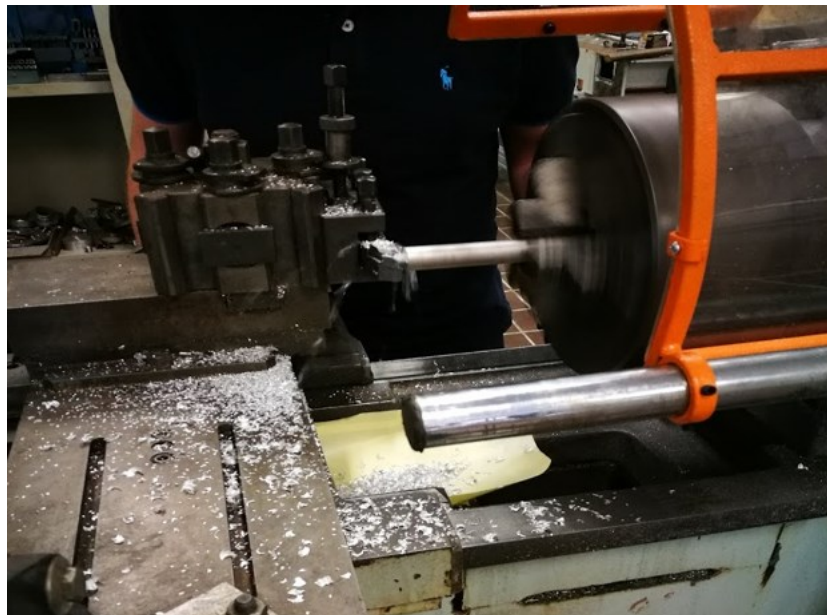
Figura 4.5 - Lavorazione al tornio delle barre di Alluminio
