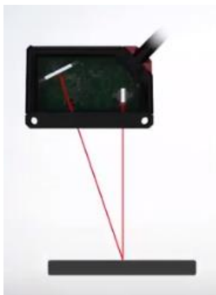
Figura 6 e 7 Sistema triangolazione laser
