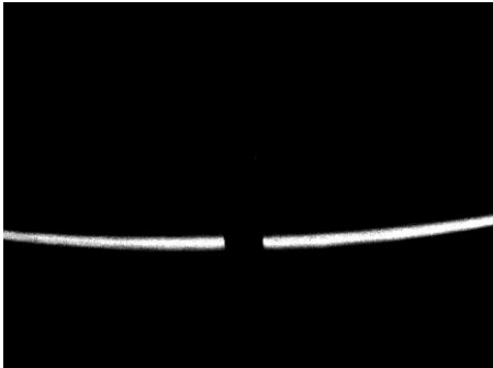
Figura 28 var. gap 5mm, flush 0,5 mm, Rz 1°
