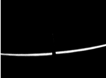
Figura 27 var. gap 3 mm, flush 1 mm, Ry 2°
