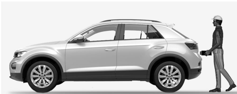
Figura 5 Addetto al controllo di gap e flush
