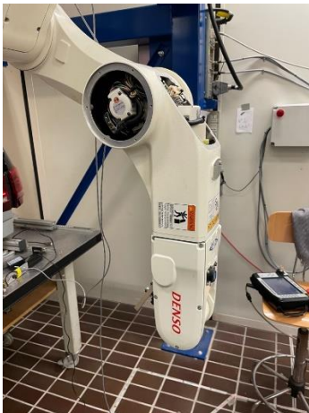
Figura 25 Braccio robotico durante la calibrazione
