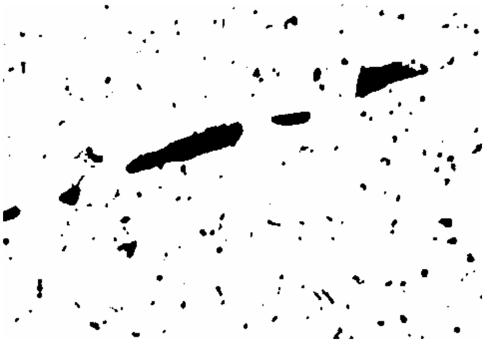
Figura 5.7-Ritaglio micrografia 2 in negativo, ingrandimento 10x0,8, campione a 400MPa
