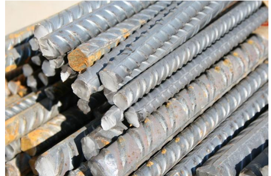
Figura 4.2-Foto di alcune barre metalliche da cui vengono estratti i provini [2]
