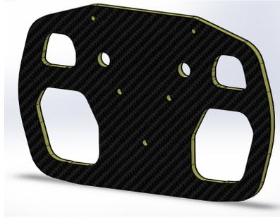
**Figura 4.4:** Struttura sandwich del volante
