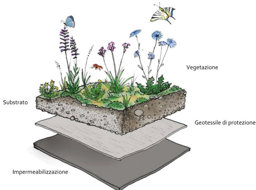
Fig. 16 Geotessile con funzione di protezione
