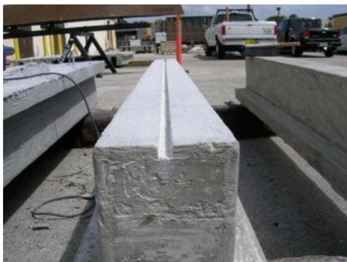
Figura 5.8. Esempio di applicazioni di rinforzi FRP con tecnologia NSM.
