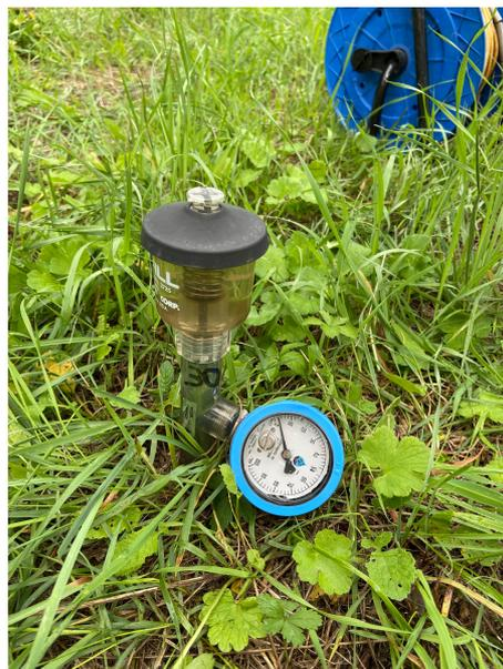
FIG 3.26 Estremità superiore del tensiometro e manometro
