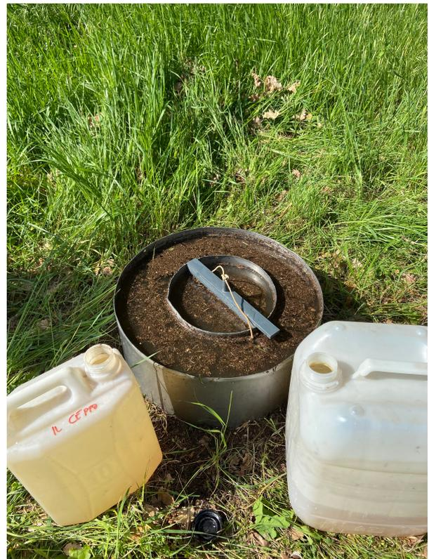
FIG 3.29 e 3.30 Riempimento dei due anelli e attesa della stabilizzazione dell'infiltrometro
