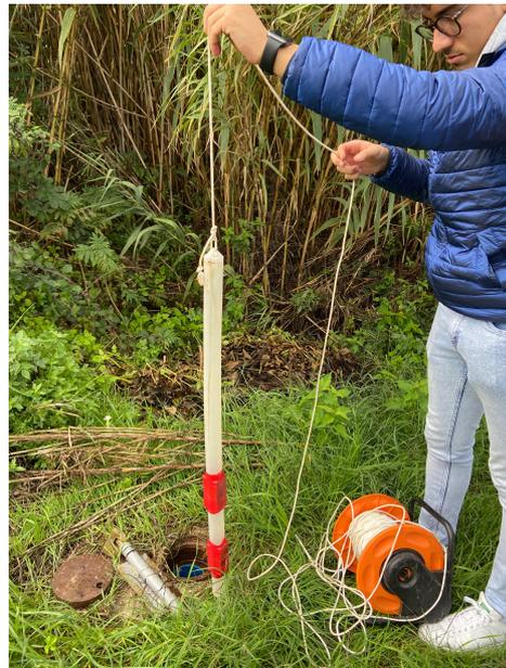
FIG 3.24 e 3.25 Inserimento ed estrazione bailer da piez. Fiume
