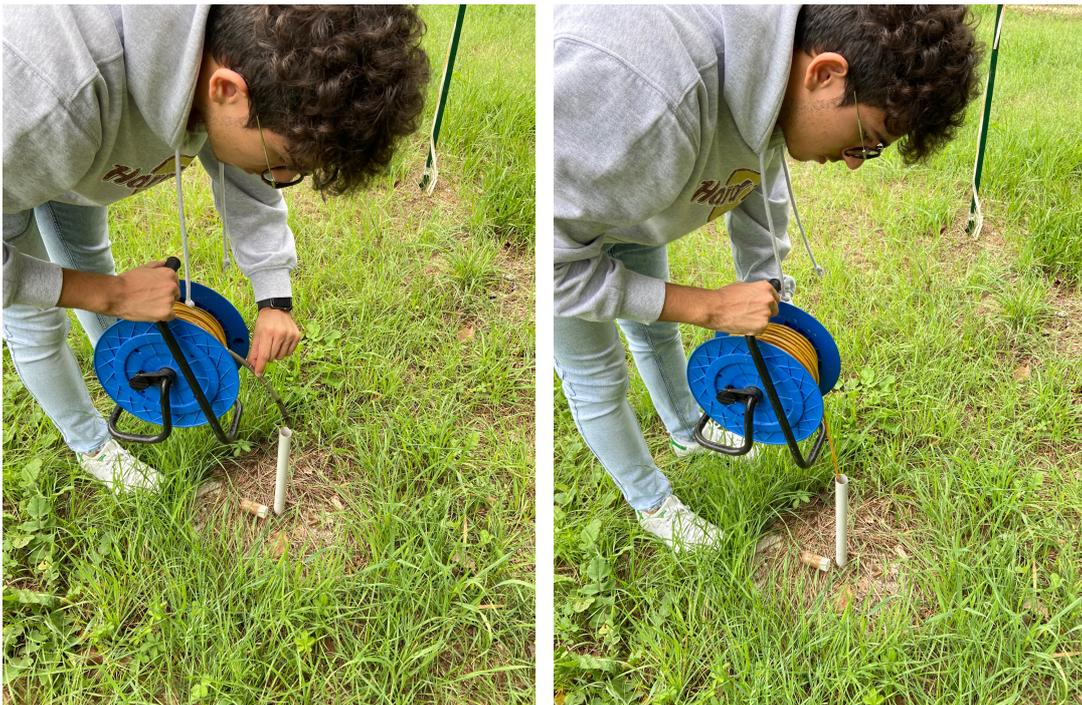
FIG 3.22 e 3.23 Inserimento della sonda del freatimetro all'interno del piezometro e discesa del cavo graduato dall'interno del piezometro
