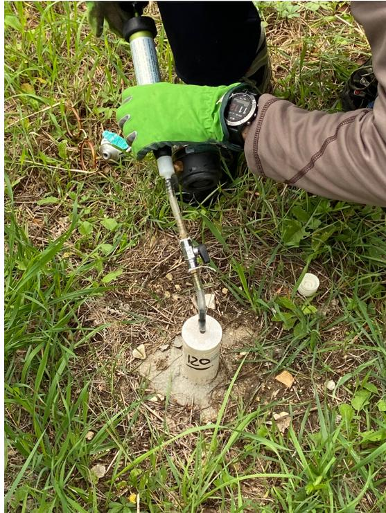
FIG 3.27 e 3.28 Estremità superiore del lisimetro e messa in pressione dello strumento attraverso la pompa
