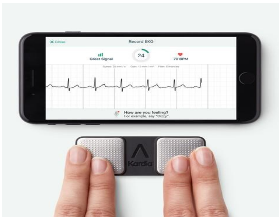
Fig.1 - In alto è presente la schermata di acquisizione di un tracciato ECG realizzata con il dispositivo Kardia (in basso).
