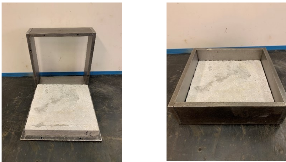
Figura 32. Inserimento della piastra nel cassero
