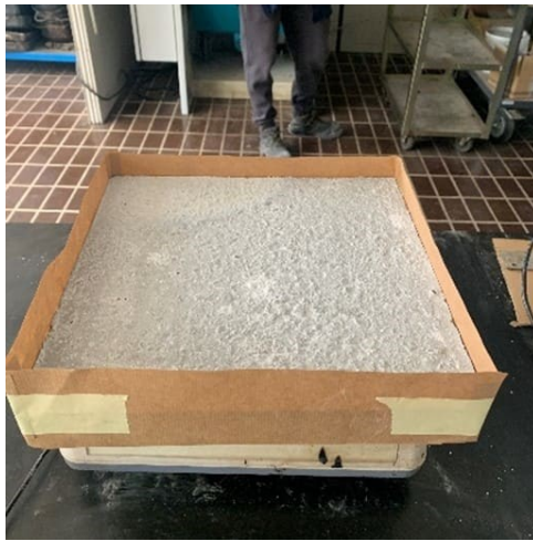
Figura 19. Preparazione piastra in calcestruzzo: realizzazione bordo di carta
