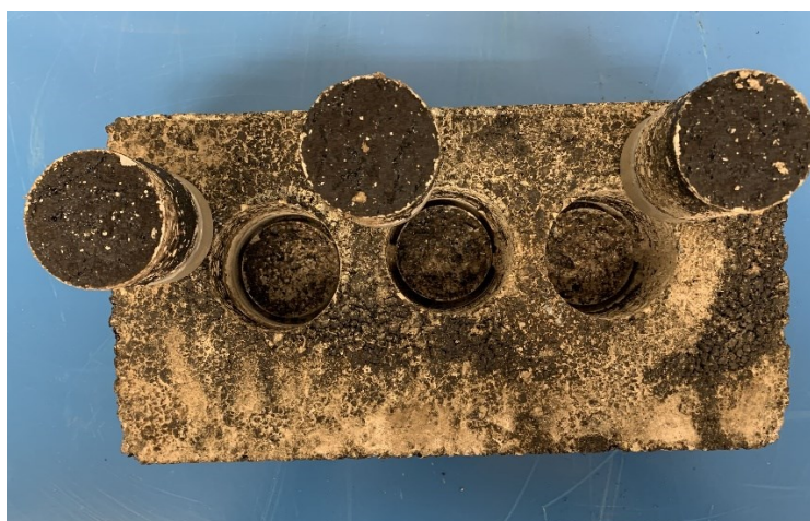
Figura 62. Rottura relativa al Geotessuto e Bitume
