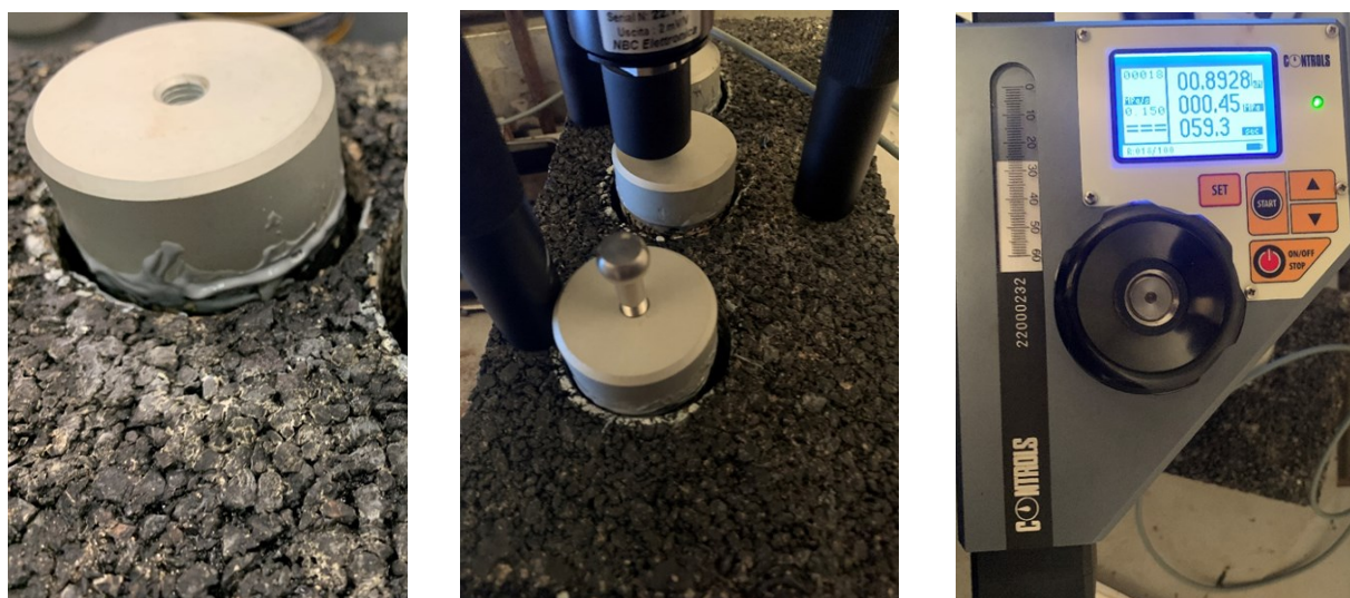
Figura 39. Fasi della prova di Pull-Off
