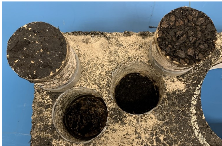
Figura 70. Rotture relative al Geocomposito C
