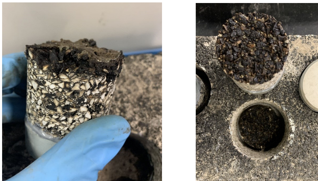
Figura 58. Provini della Resina Bicomponente
