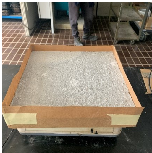
Figura 28. Preparazione piastra con bordo di carta
