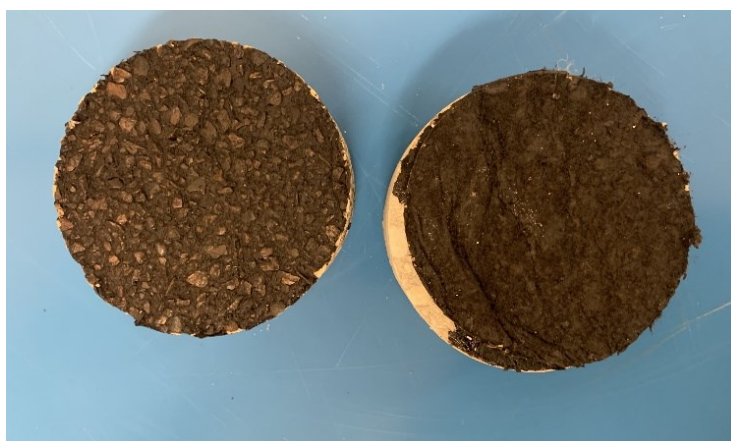
Figura 49. Rottura relativa al Geocomposito A
