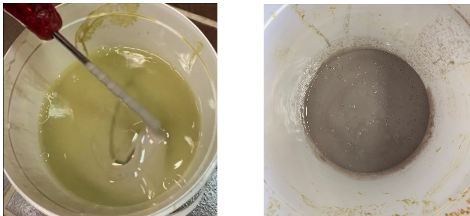
Figura 21. Componente B correttamente mescolata
