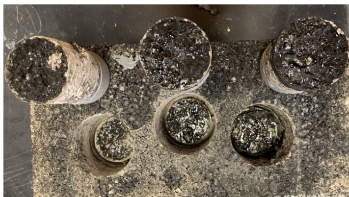
Figura 73. Rotture relative al Geocomposito D
