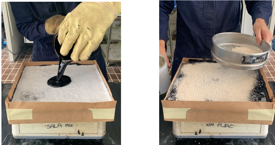
Figura 30. Esecuzione dello spolvero
