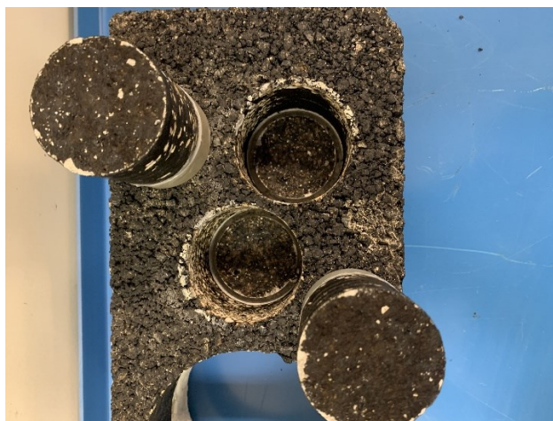
Figura 61. Rottura relativa al Geotessuto e Bitume
