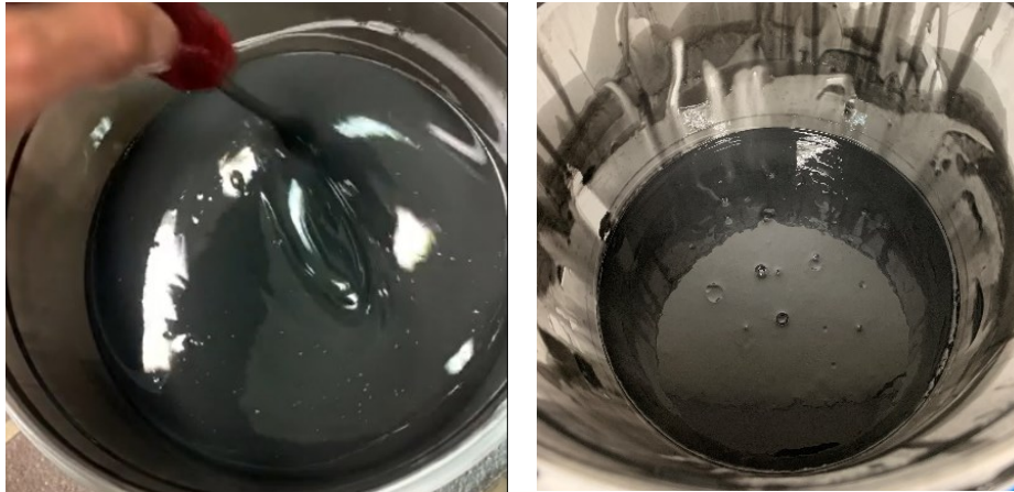
Figura 20. Componente A correttamente mescolata
