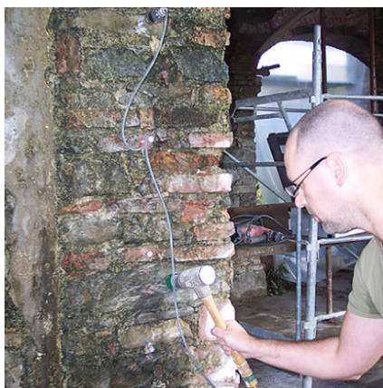
Figura 1.29: Esecuzione di una prova sonica su muratura
