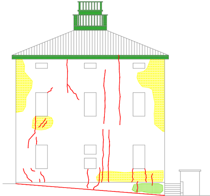
Figura 2.22: Quadro fessurativo prospetto Est.
