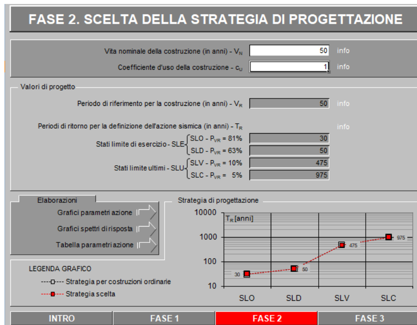
Figura 2.39: Fase 2: vita nominale e coefficienti d'uso.
