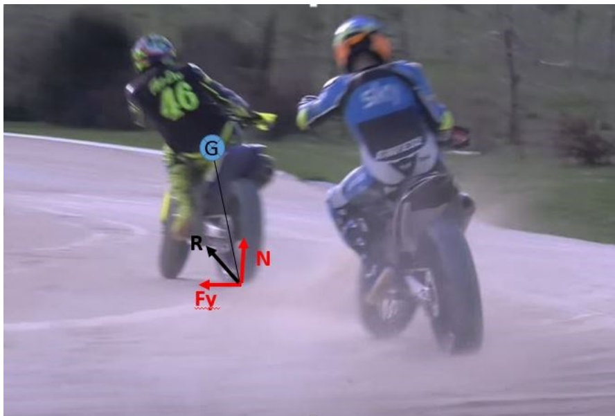
Figura 29: carico generato dal recupero di aderenza
