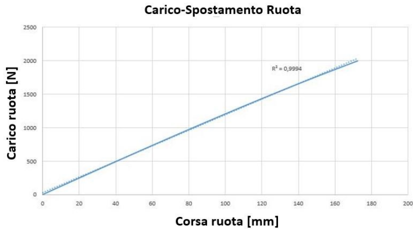
Figura 18: curva carico-spostamento ruota posteriore
