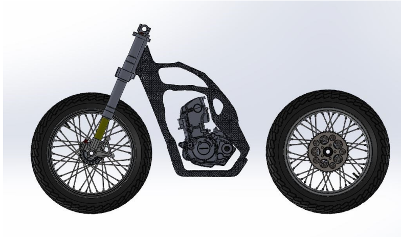
Figura 48: assieme moto con telaio ottimizzato
