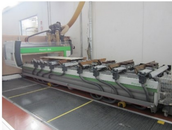
Figura 43: Foratura e fresatura pannelli
