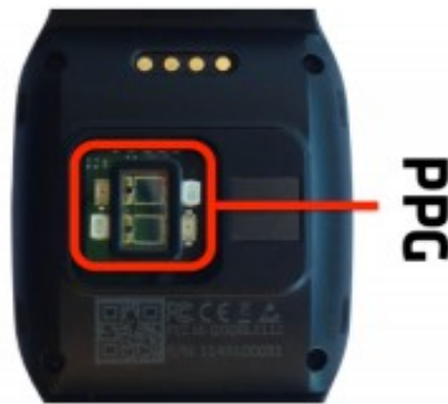
Figura 13 - Sensore PPG sul dispositivo Empatica E4.
