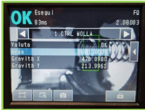
Figura 51 "Verifica presenza della molla di compressione".
