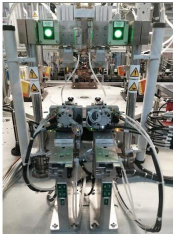
Figura 53 "Stazione di tenuta ad aria"
