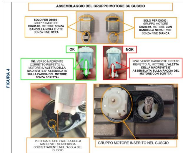
Figura 44 "Estratto PFC della stazione ST90 della linea di assemblaggio NPS"
