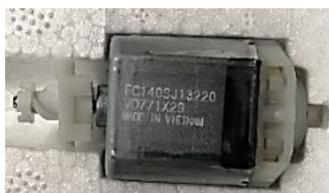
**Figura 50 "Motore con PTC"**
