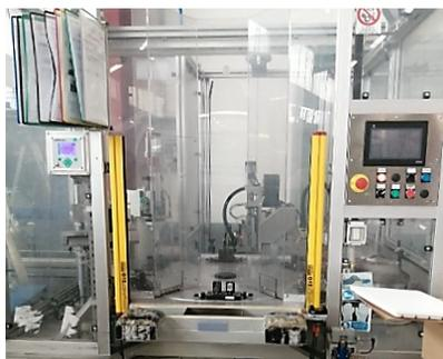
**Figura 65 "Tavola esterna PIA01 per il piantaggio della vite sul motore"**
