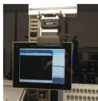
Figura 47 "Smart camera OMRON FHV7 in linea di assemblaggio".
