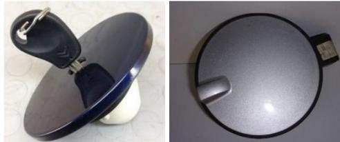
Figura 15 “Esempio tappo serbatoio carburante e sportello carburante a unghiate”. Fonte: Google.
