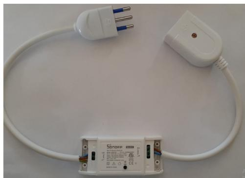
Come spiegato precedentemente questa soluzione permette di spostare il sonoff in qualunque momento. Una volta effettuato il cablaggio si dovrà collegare il sonoff dal server OpenHAB.
